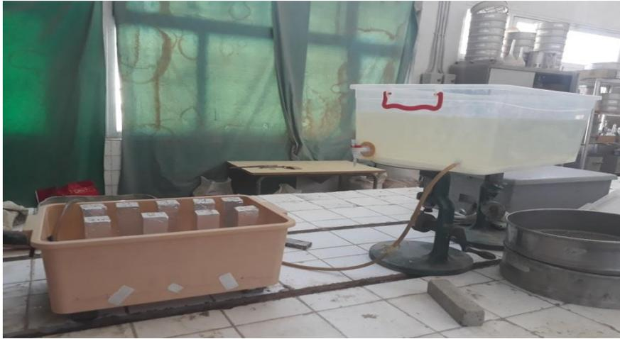
**Figure 2.14.** Essai d'absorption d'eau par capillarité
