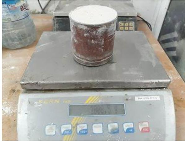
**Figure 2.10.** Mesure de la masse volumique réelle
