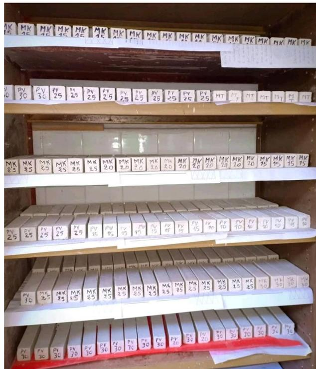
Figure 2.8. Conservation des éprouvettes
