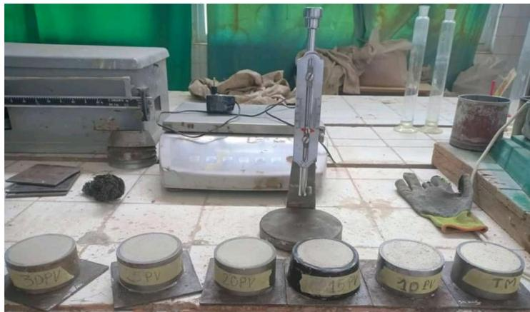
**Figure 2.11.** Détermination des délais de prise avec l'Appareil de Vicat
