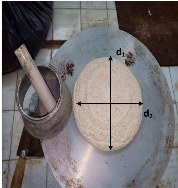
**Figure 2.9.** Etalement à la table à secousses d'un mortier de chaux
