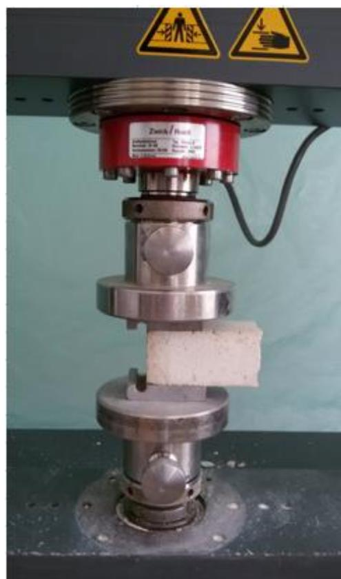
**Figure 2.13.** Essai de Compression
