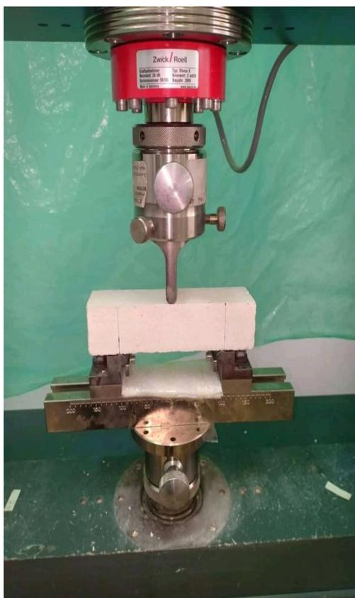
**Figure 2.12.** Essai de traction par flexion 3 points
