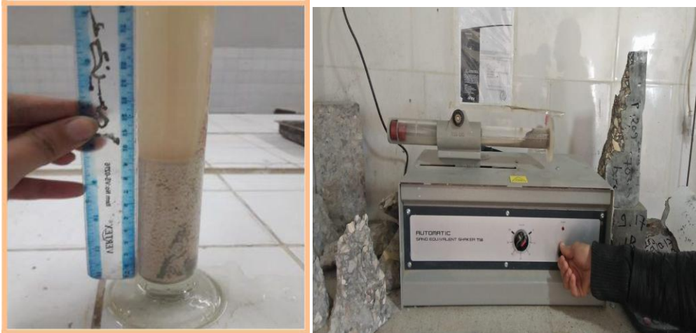
Figure II.7: Dispositif de l'essai de l'équivalent de sable
