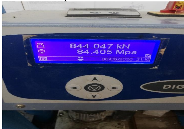
Figure III.10. Résultat de résistance BHPL a l'échéances de 90jours
