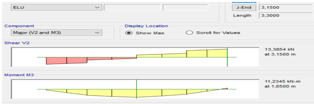
Figure 2 :Diagramme Moment, Effort tranchant à L'ELU
