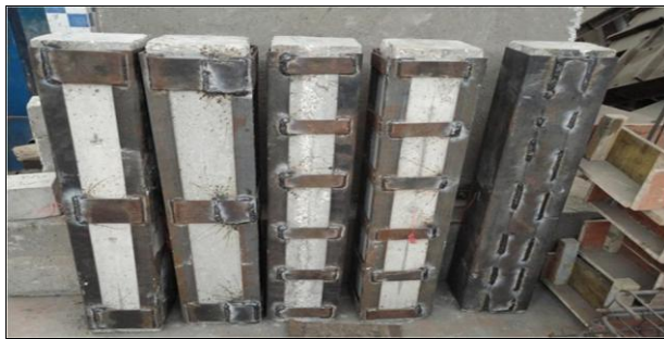
Figure 12 : Différents types de chemisage en acier
