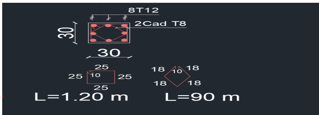
Figure(VI.9) : Schéma ferrailage de poteau (2 ème _4 ème )
