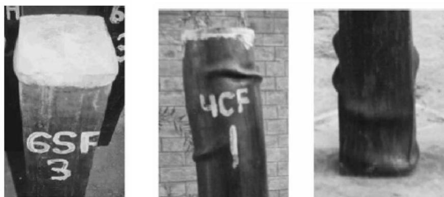
**Figure I.15** Modes de ruptures des spécimens des poteaux mixtes de section carré et circulaire [20]
