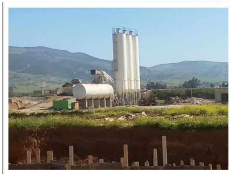
Figure X.18 Centrale à béton
