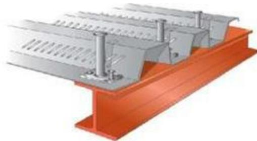
**Figure VI.5 :** disposition des connecteurs
