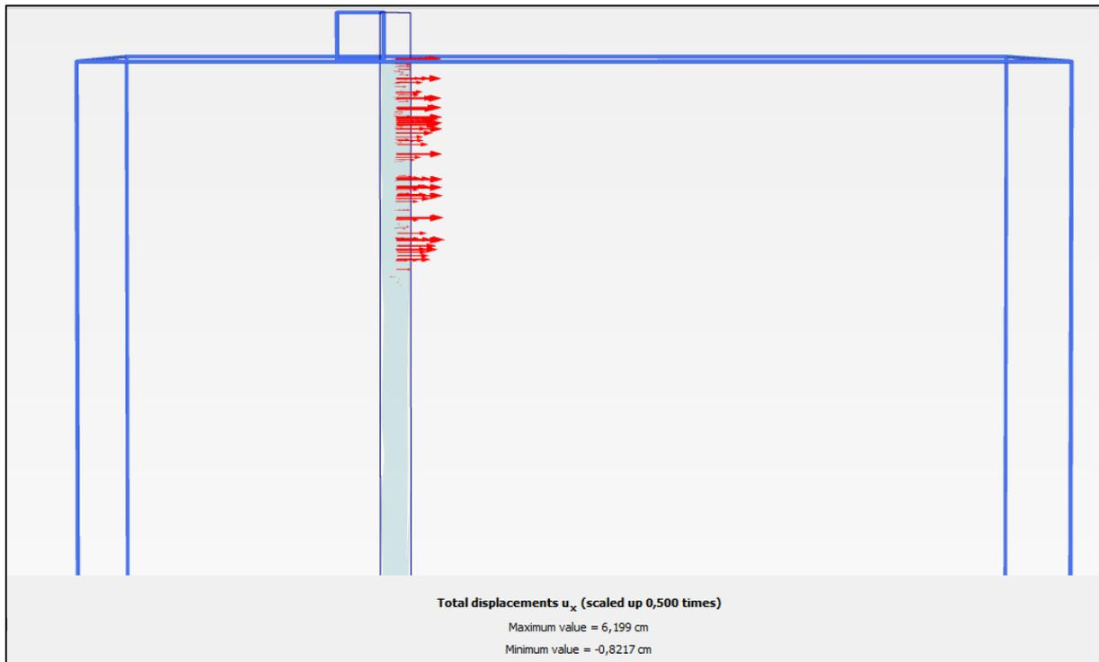
Fig V.3.b : coupe verticale de direction du déplacement  $U_x$ .
