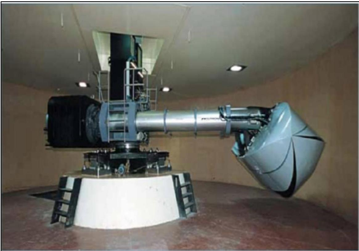
Figure I.8 : Centrifugeuse au laboratoire LCPC (dispositif moderne).
