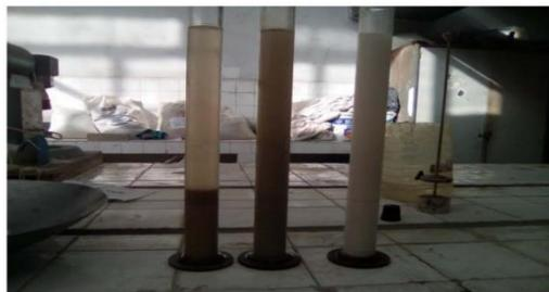
**FigureII.1 : Essai de équivalent sable**
