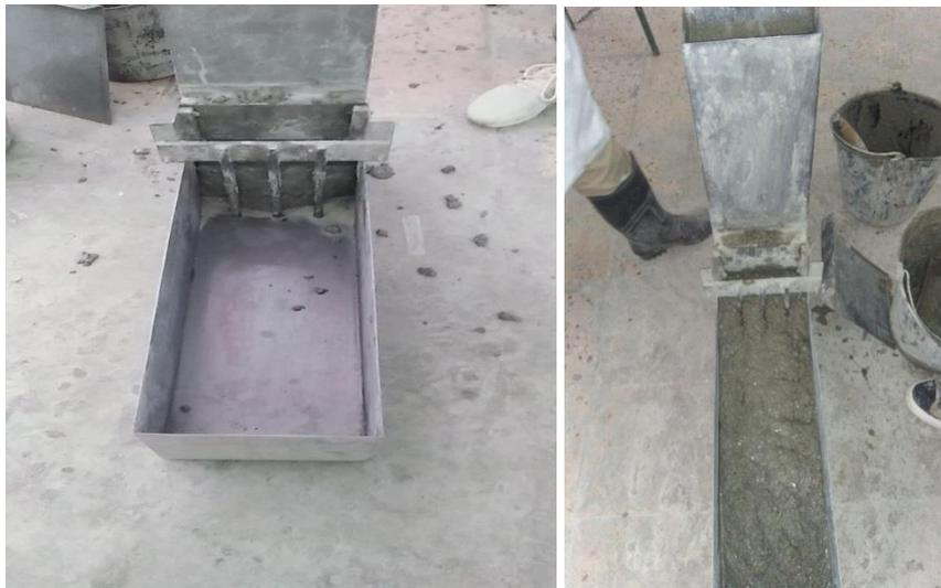
**Figure I.3 :** Essais d'écoulement à la boîte L-box ou boîte en L
