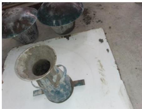
**Figure I.2 :** Essai d'étalement
