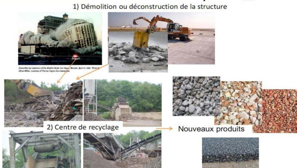
**Figure I.5 : Les étapes de la production des granulats recyclés.**
