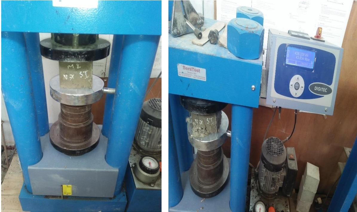
**Figure III.21 :** Dispositif de l’essai d’écrasement des éprouvettes à la compression
