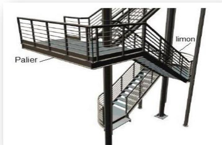
**Figure IV.6 :** Escalier en charpente métallique.
