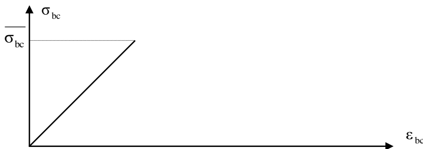
Figure I.2 : Diagramme contrainte – déformation du béton à l'ELS
