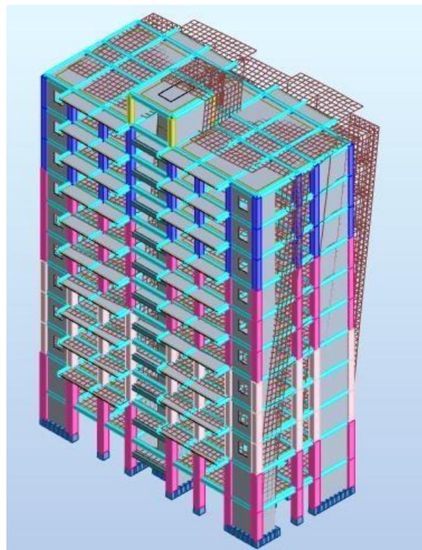
**Figure (IV.7) :** 2<sup>ème</sup> mode de déformation de la structure à cause des efforts sismiques
