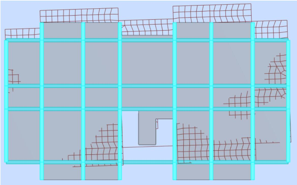
**Figure (IV.4) :** 2<sup>ème</sup> mode de déformation de la structure à cause des efforts sismiques dans le plan X-Y (résultats de **Robot 2017**).
