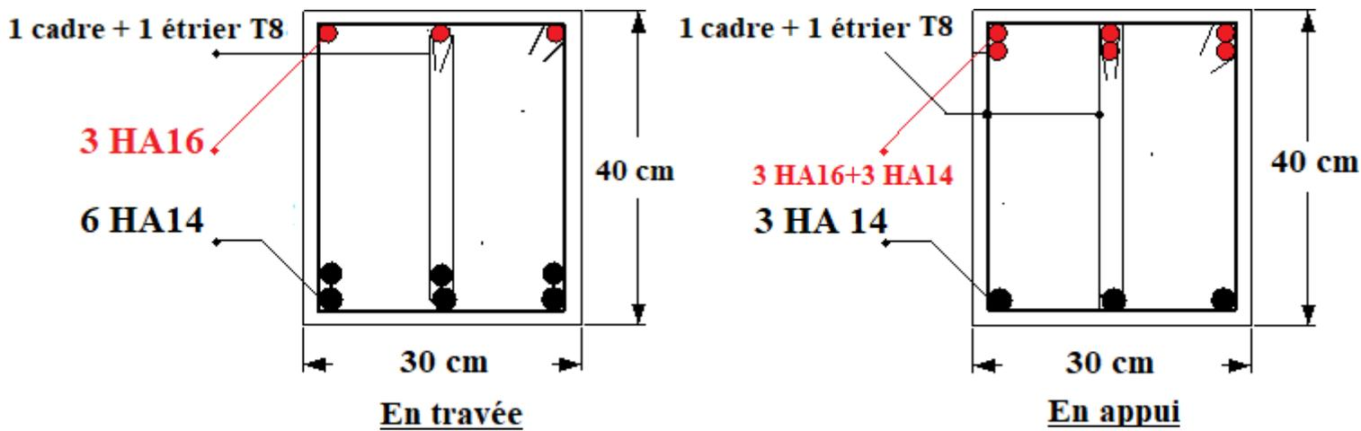
Figure (V.8) : Schéma de ferrailage des poutres principales d'étage 5, 6, 7.
