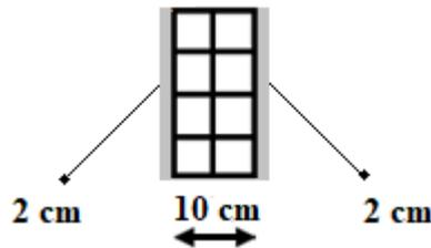
**Figure (II.11) : Mur intérieur**
