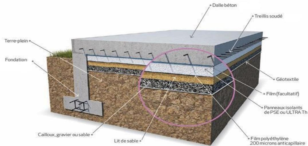
**Figure III-18:** Schéma de dalle flottante sur terre plein.
