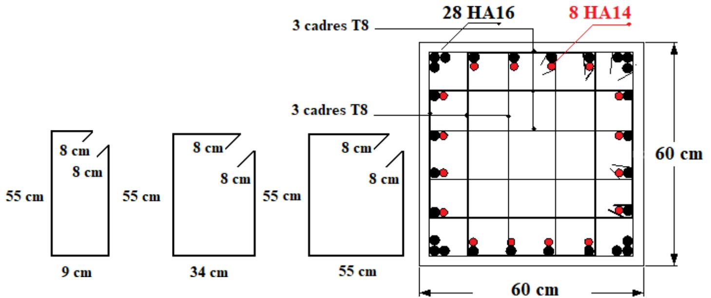
Figure (VI.4) : Schéma de ferrailage des poteaux section 60×60 cm<sup>2</sup>
