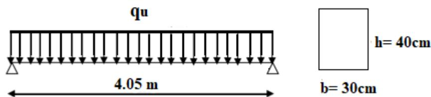
**Figure (III.16) :** Schéma statique de la poutre palière
