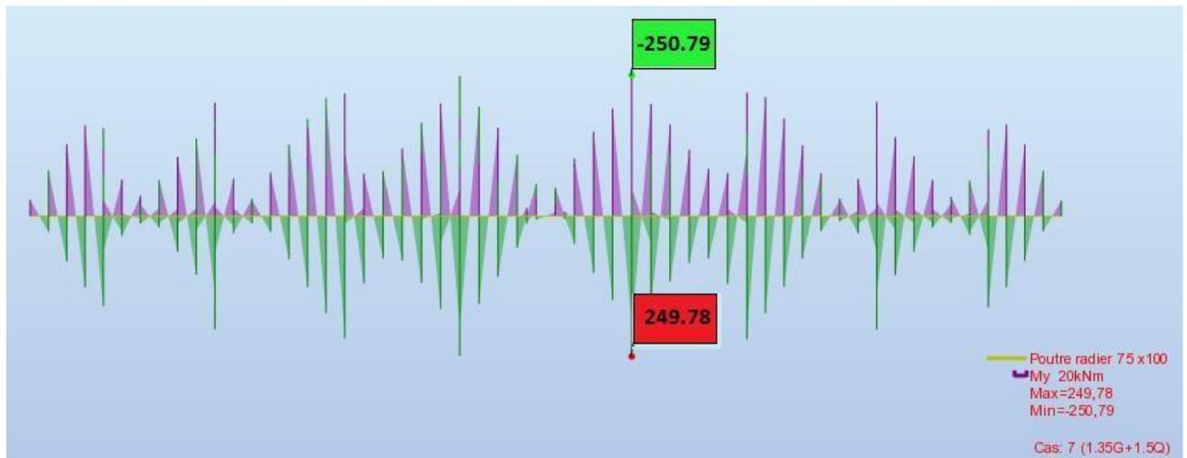
**Figure (VI.11) :** Exemple des diagrammes des moments agissants aux niveaux des nervures
