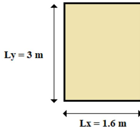
**Figure (III.12) : Schéma de la dalle machine**
