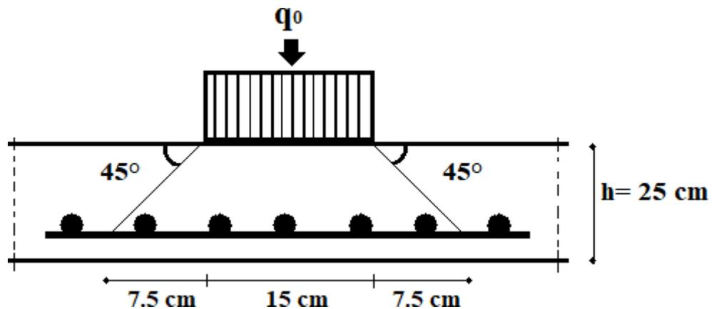
**Figure (III-13) :** Représentation de la charge concentrée au niveau de la dalle machine
