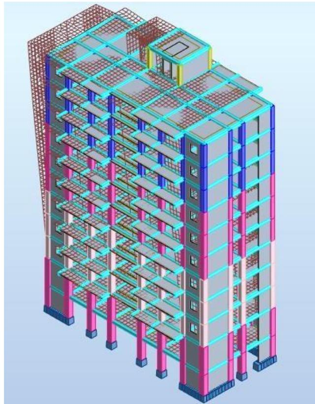
**Figure (IV.6) :** 1<sup>er</sup> mode de déformation de la structure à cause des efforts sismiques
