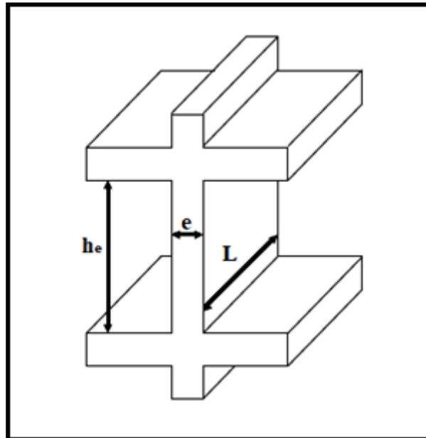
**Figure (II.6) : Coupe de voile en élévation**
