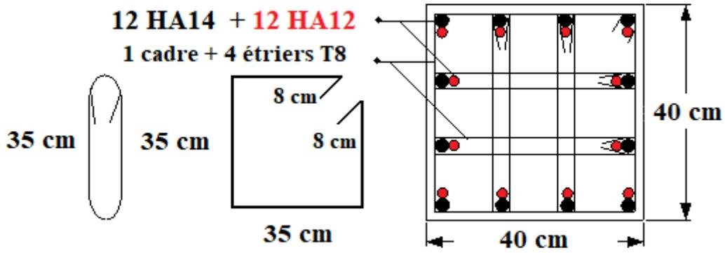
Figure (V.1) : Schéma de ferrailage des poteaux section 40×40 cm<sup>2</sup>
