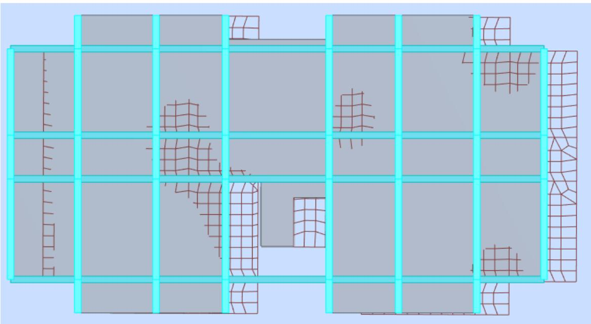
**Figure (IV.3) :** 1<sup>er</sup> mode de déformation de la structure à cause des efforts sismiques dans le plan X-Y (résultats de **Robot 2017**).
