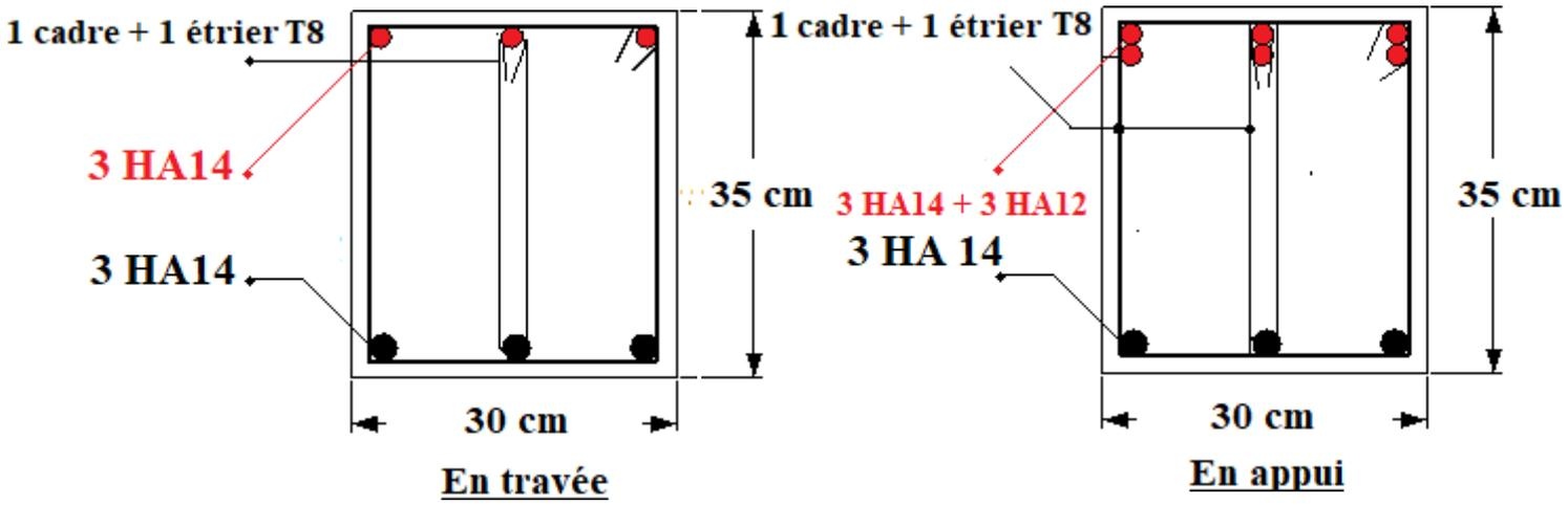
Figure (V.11) : Ferrailage des poutres secondaires de 2<sup>ème</sup> à 9<sup>ème</sup> étage.
