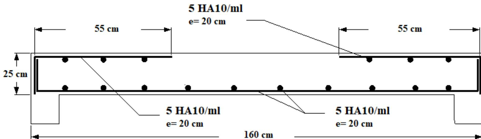
**Figure (III-14) : Ferrailage de la dalle machine**
