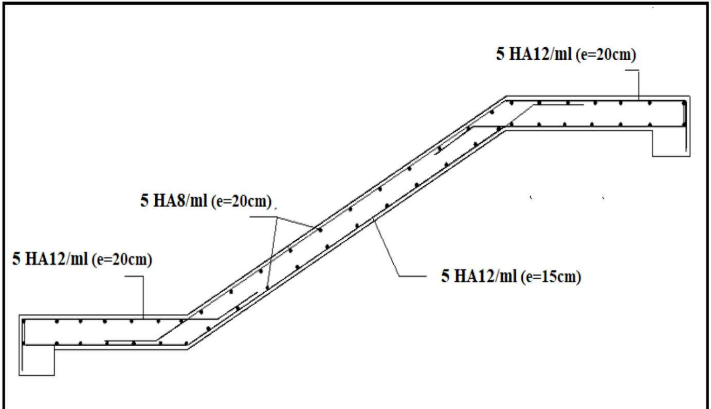
**Figure (III.15) :** Schéma de ferrailage de l'escalier
