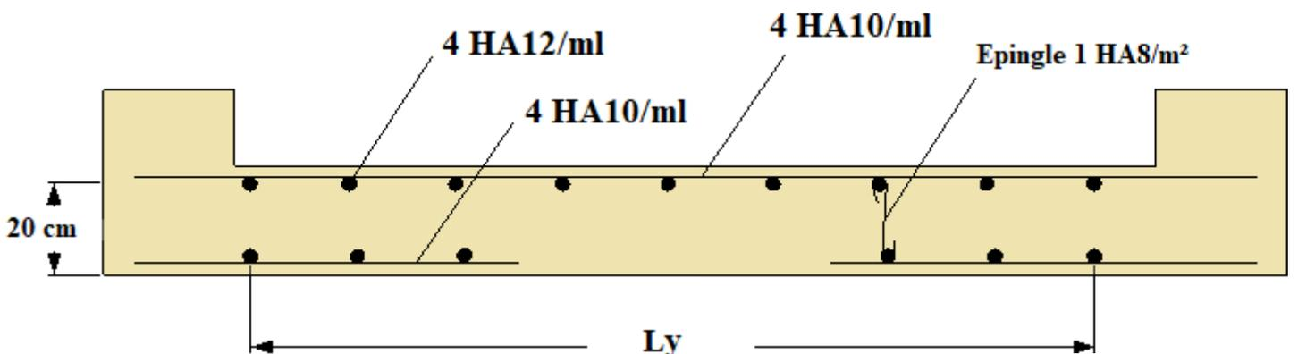
**Figure (VI.16) : Schéma de ferrailage du voile périphérique**
