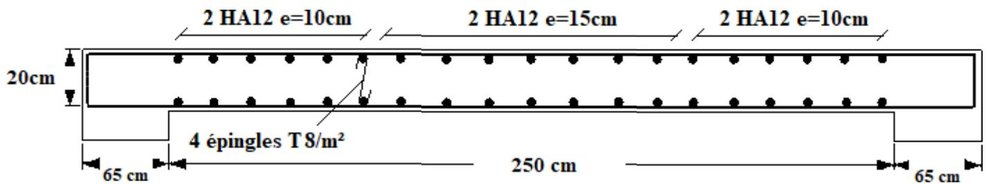
**Figure (V.14) :** Ferrailage horizontal du voile transversal au niveau RDC.
