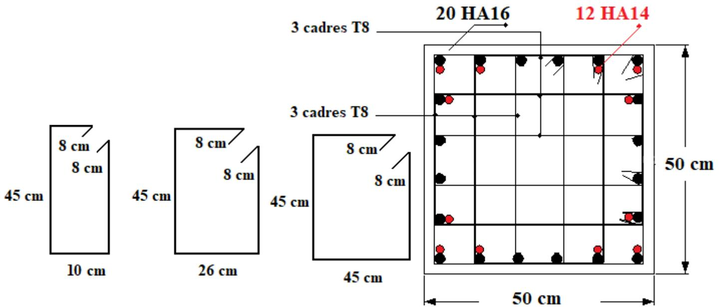
Figure (V.2) : Schéma de ferrailage des poteaux section 50×50 cm<sup>2</sup>
