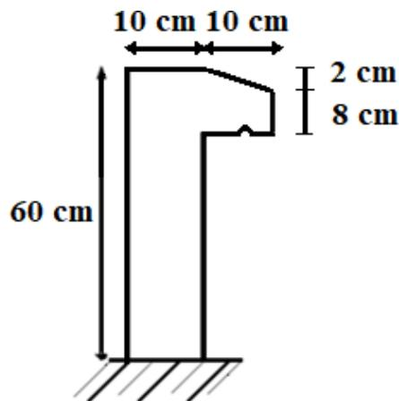
**Figure (II.12) :** Schéma de l'acrotère (terrasse inaccessible)
