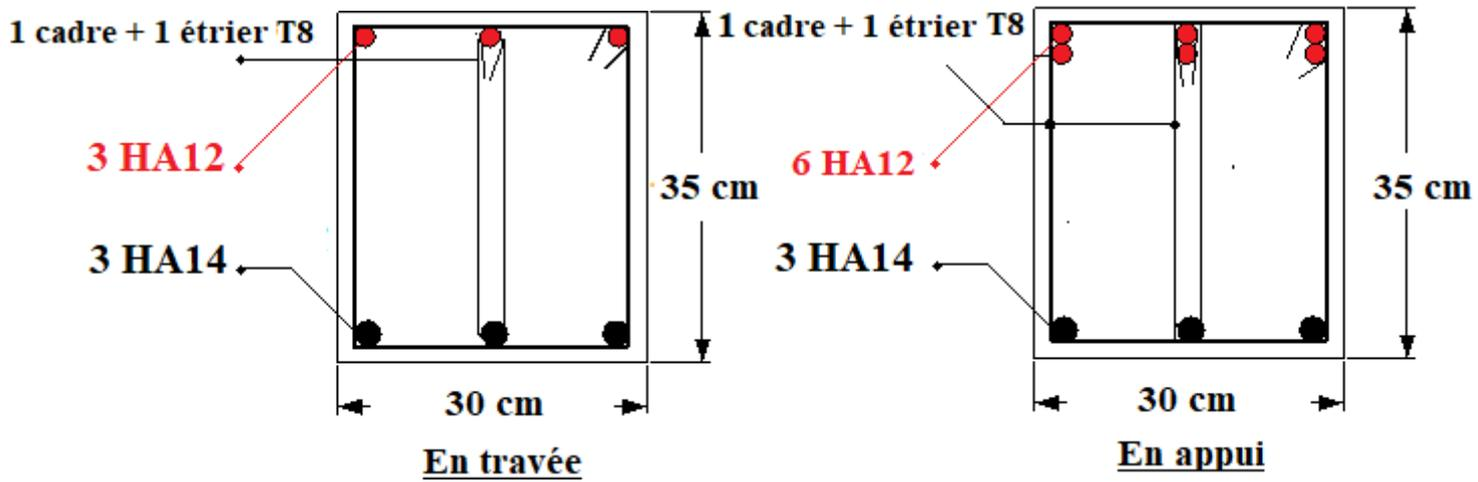
Figure (V.12) : Ferrailage des poutres secondaires au niveau RDC, 1<sup>ème</sup> et de buanderie.
