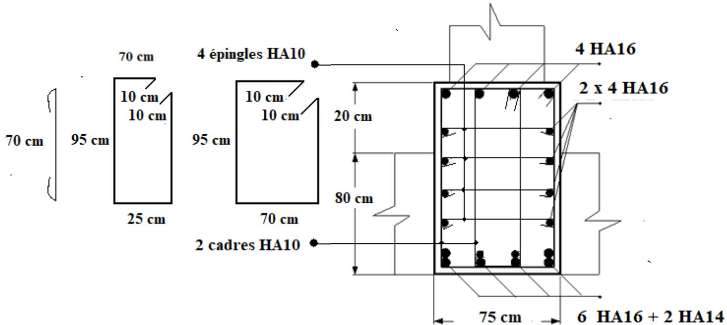
**Figure (VI.13) :** Coupe de ferraillage des nervures aux niveaux d'appuis
