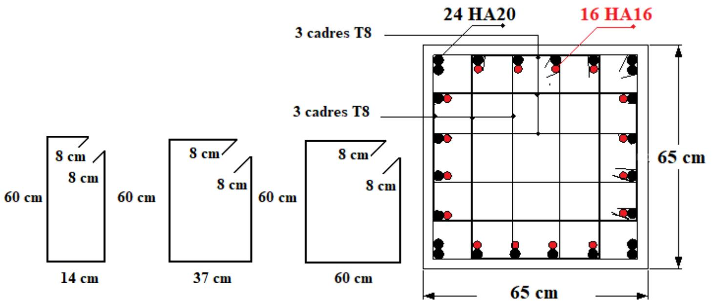
Figure (V.5) : Schéma de ferrailage des poteaux section 65×65 cm<sup>2</sup>
