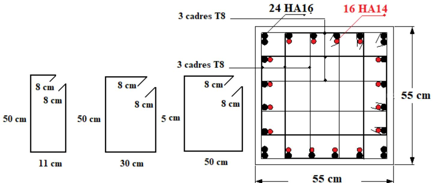
Figure (V.3) : Schéma de ferrailage des poteaux section 55×55 cm<sup>2</sup>
