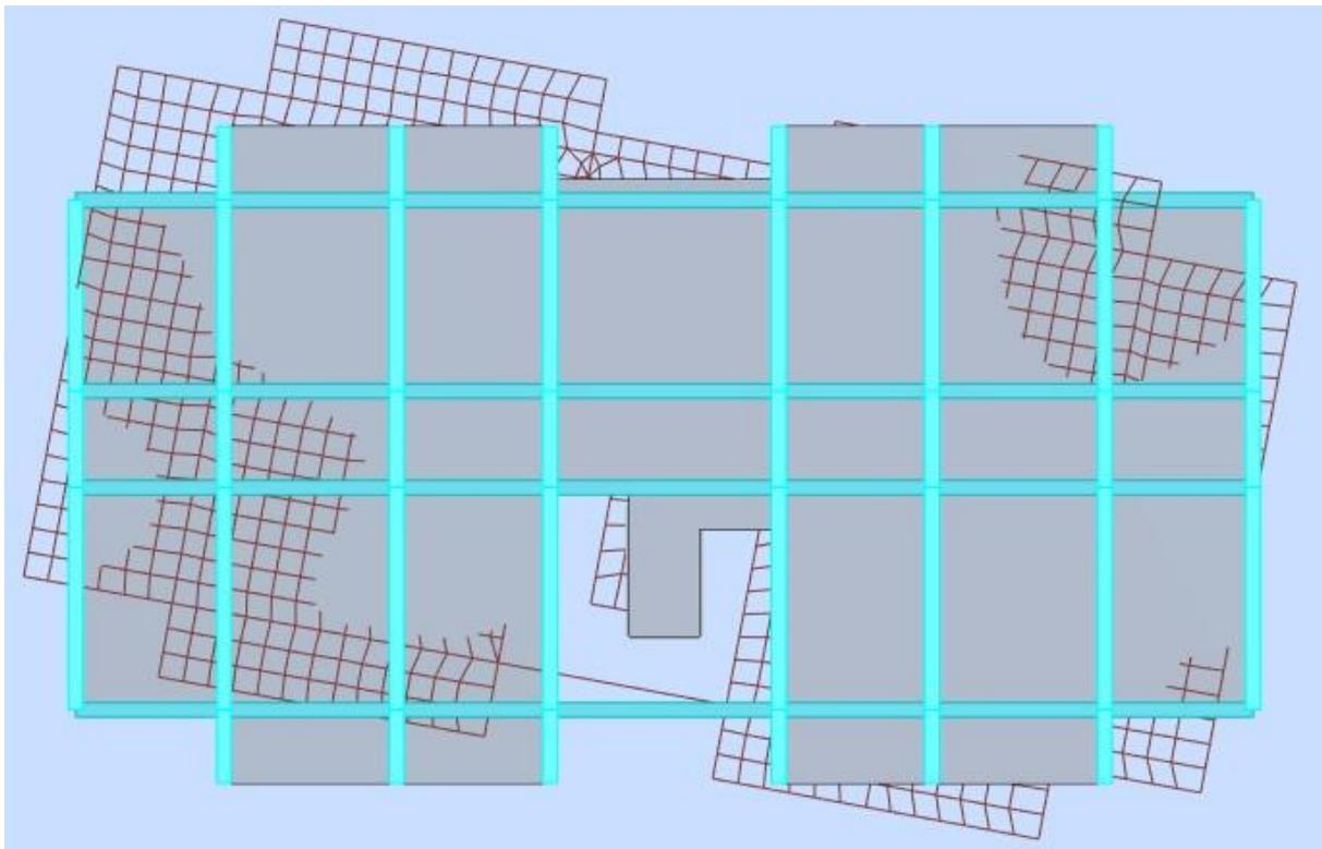
**Figure (IV.5) :** 3<sup>ème</sup> mode de déformation de la structure à cause des efforts sismiques vue: X-Y (résultats de **Robot 2017**).
