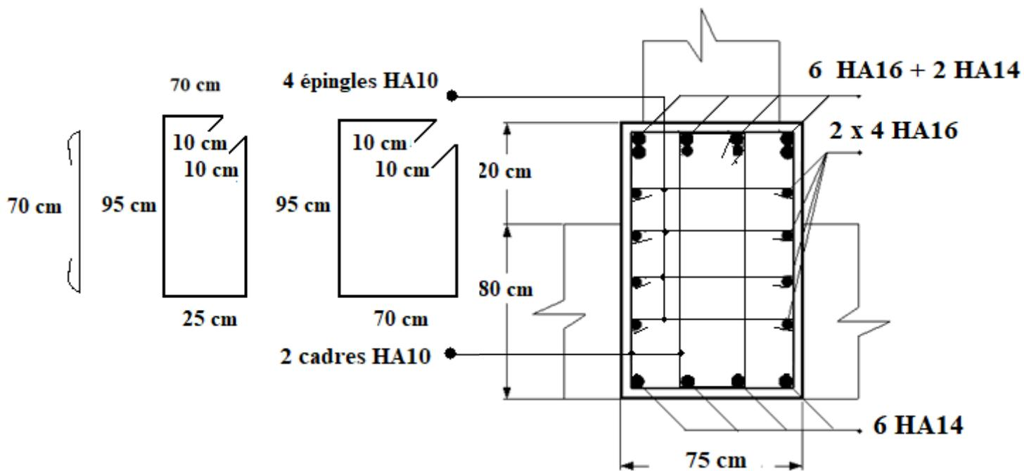
**Figure (VI.14) :** Coupe de ferraillage des nervures aux niveaux de travée
