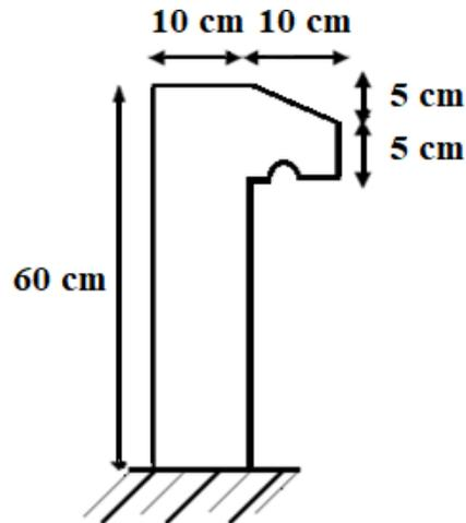
**Figure (II.4) :** Schéma de l'acrotère (terrasse inaccessible)
