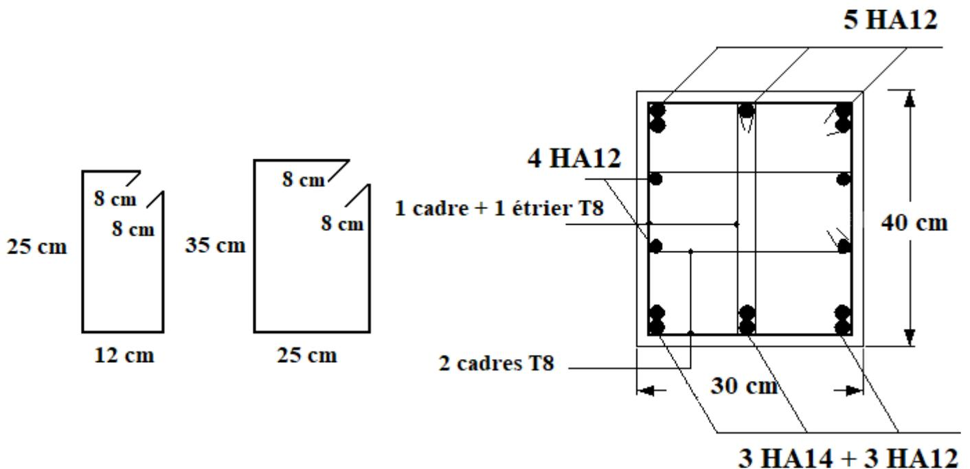
**Figure (III.17) :** Schéma de ferrailage de la poutre palière
