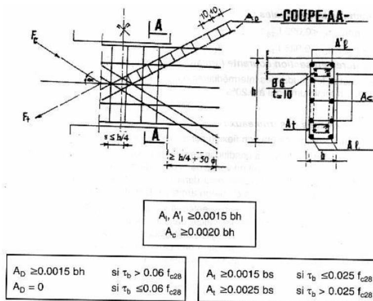
**Figure (V.15) :** Ferrailage du linteau de 1<sup>er</sup> étage selon RPA/99 version 2003.
