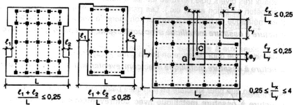
**Figure (IV.1) : Limites des décrochements en plan.**
