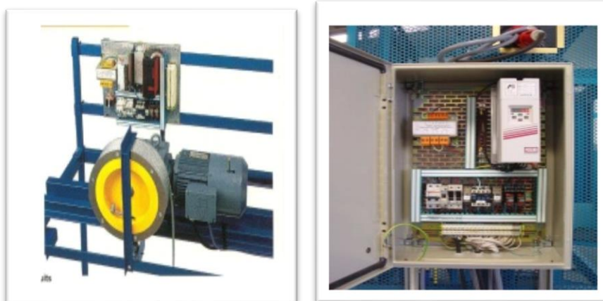
Fig .1.12 Le treuil. Fig.1.13 L'armoire de manœuvre.
