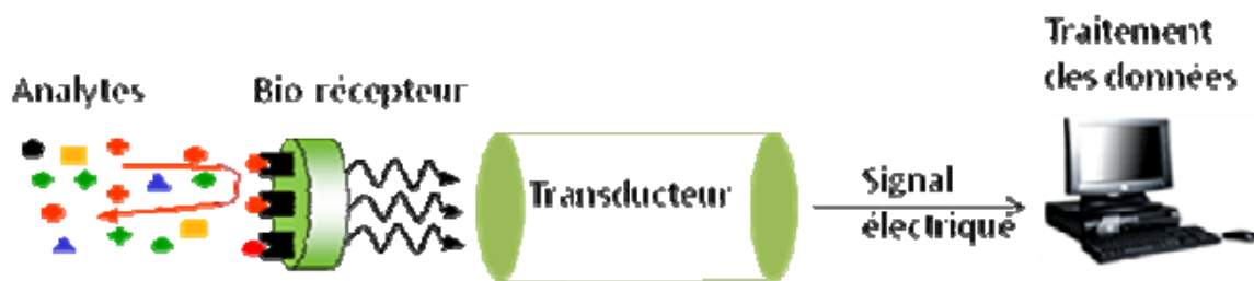
Figure (1.11) : Schéma représentatif d'un biocapteur
