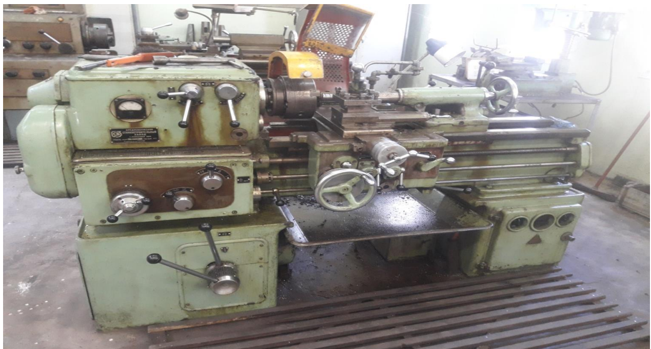
Figure III.1 : Tour universel modèle AI616 fabriqué en URSS
