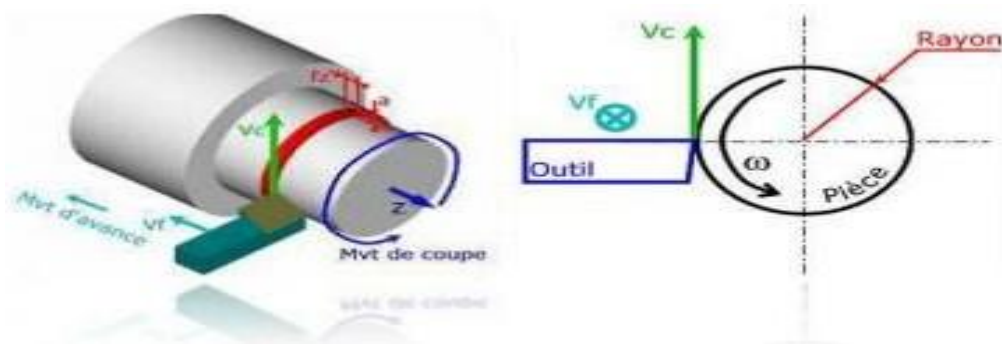
Figure I.3 les mouvements relatif entre la pièce et l'outil [2]
