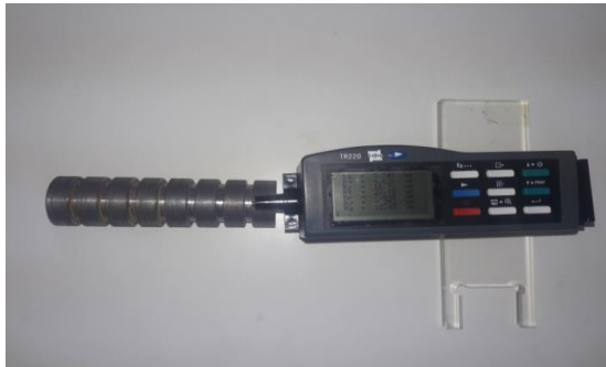
Figure III.06. Dispositif pour mesurer la rugosité
