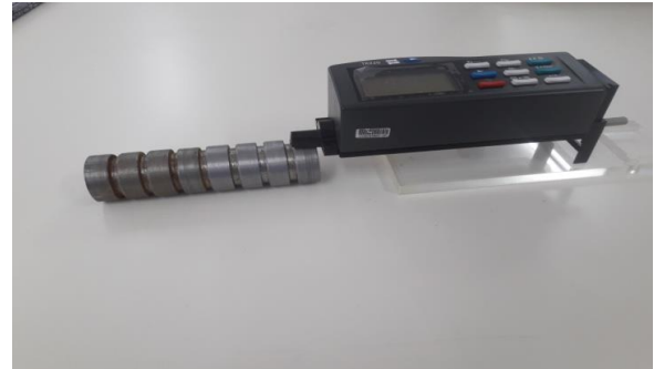
Figure III.06. Dispositif pour mesurer la rugosité
