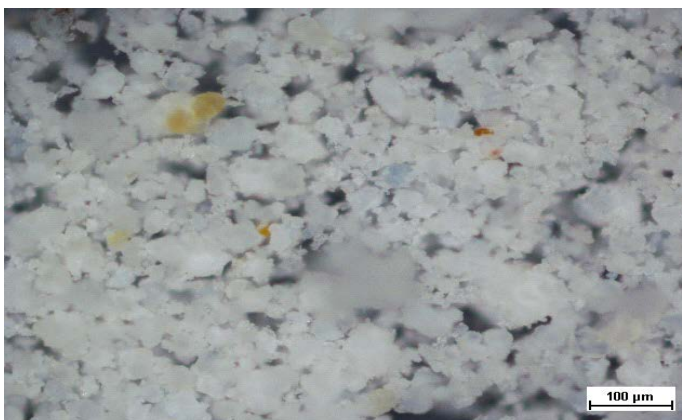
Figure IV.7 : spectroscopie optique du Bnt-brut
