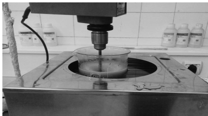
Figure IV.3 : lavage par H 2 O 2
