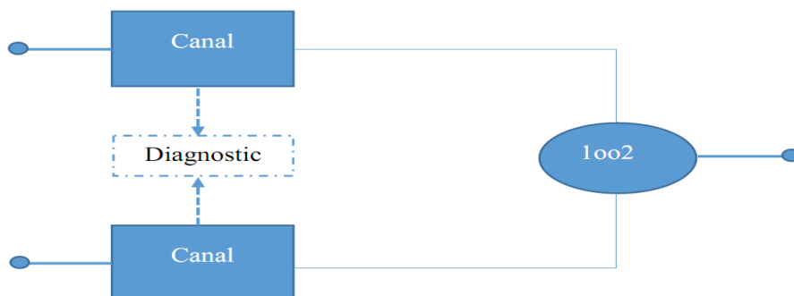
Figure 1. 6: Diagramme du bloc physique 1oo2.
