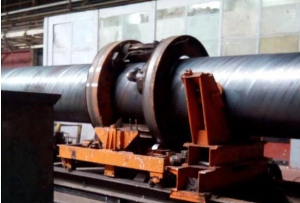
**Figure IV.16 :** Oxycoupage des tubes.
