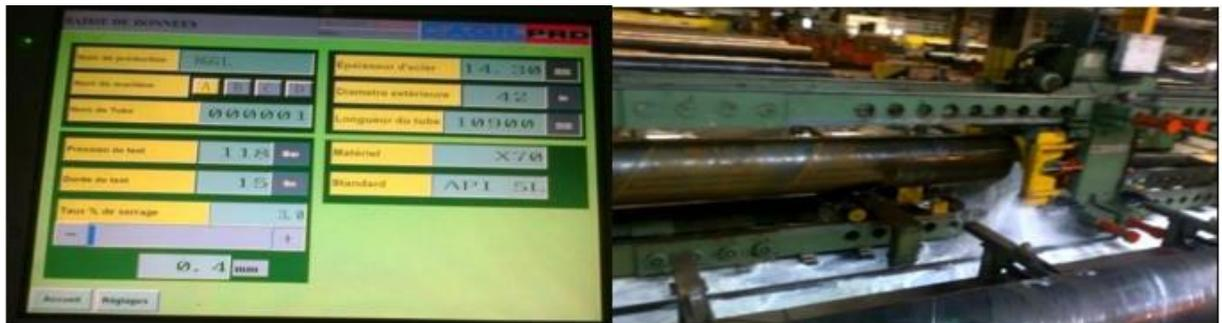
**Figure III.8** : Contrôle hydrostatique.
