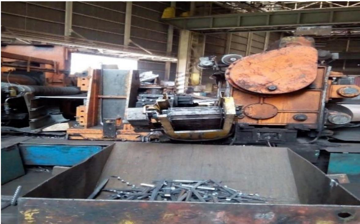
**Figure IV.8 :** Bloc cisailage des rives.
