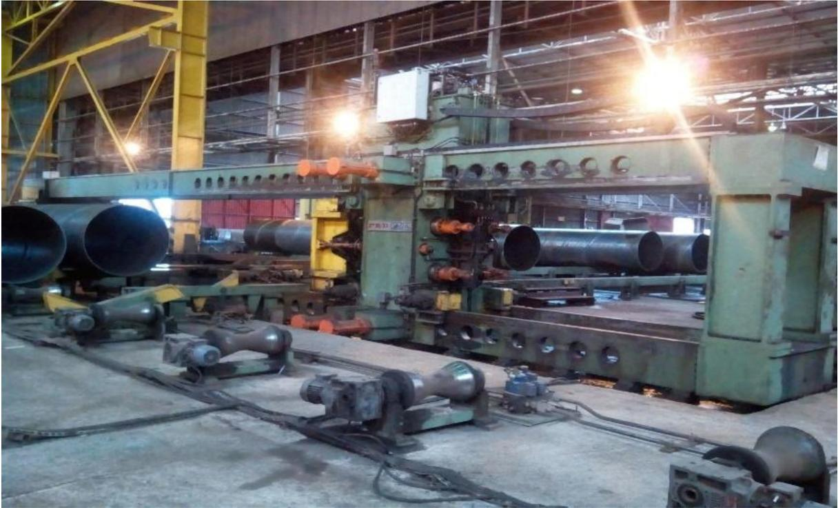
**Figure IV.19 :** Banc d'essai hydrostatique.
