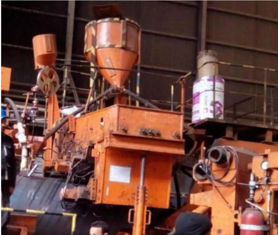
**Figure IV.13** : machine à régénérer le flux.
