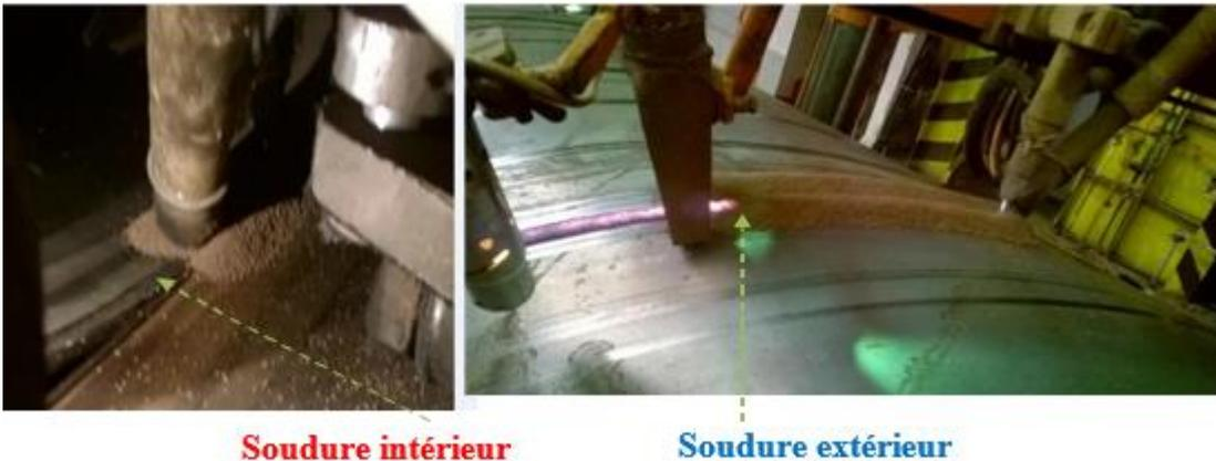
**Figure III.6** : Soudage extérieur et intérieur.
