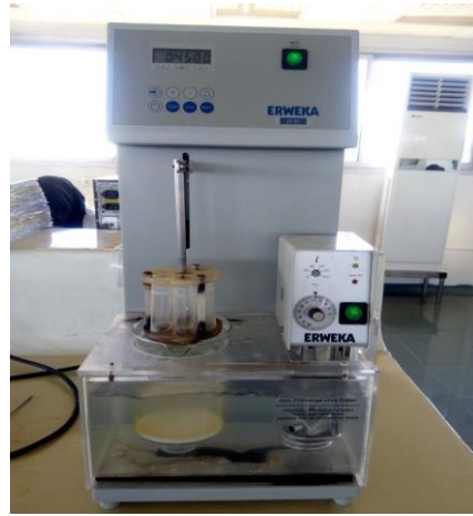
Annexe III.9 : Appareil de Délitement.
