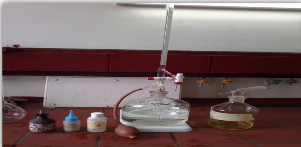
Figure IV – 3 : Dosage volumétrique du T_{Ca^{++}}
