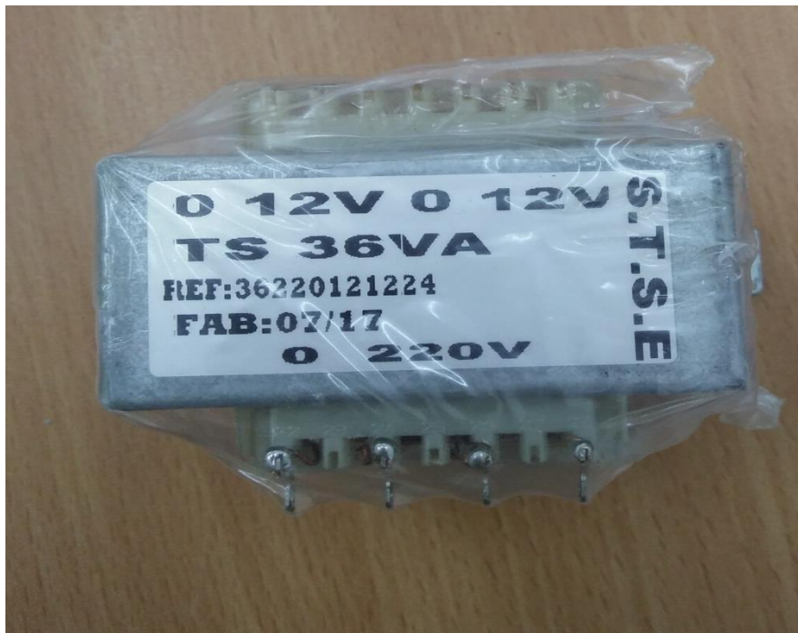
Figure (11)- Transformateur 2 ×12 utilisé .
