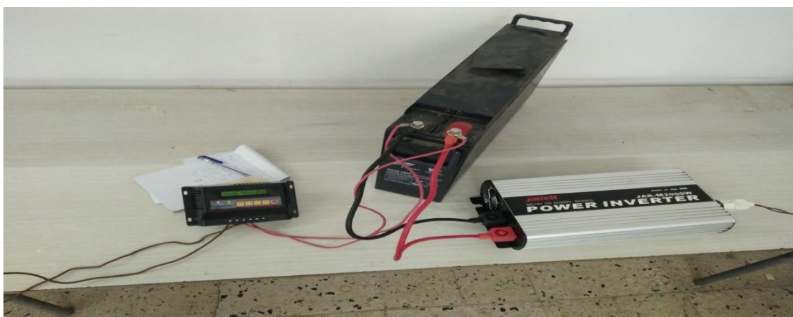
Figure (V.4)- L'association des convertisseur DC/DC et le AC/DC avec le batterie .
