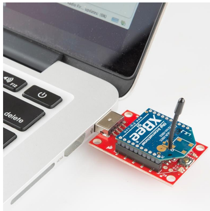
Figure 8: Exemple d'interfaçage en un PC et un XBee
