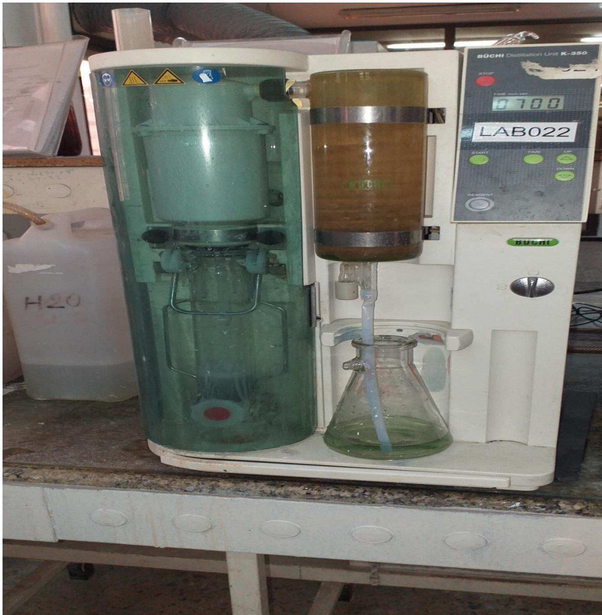
Figure.III-7 : Le dosage d'Azote total par un distillateur d'Azote Kjeldahl (BÜCHI Distillation Unit K-350).
