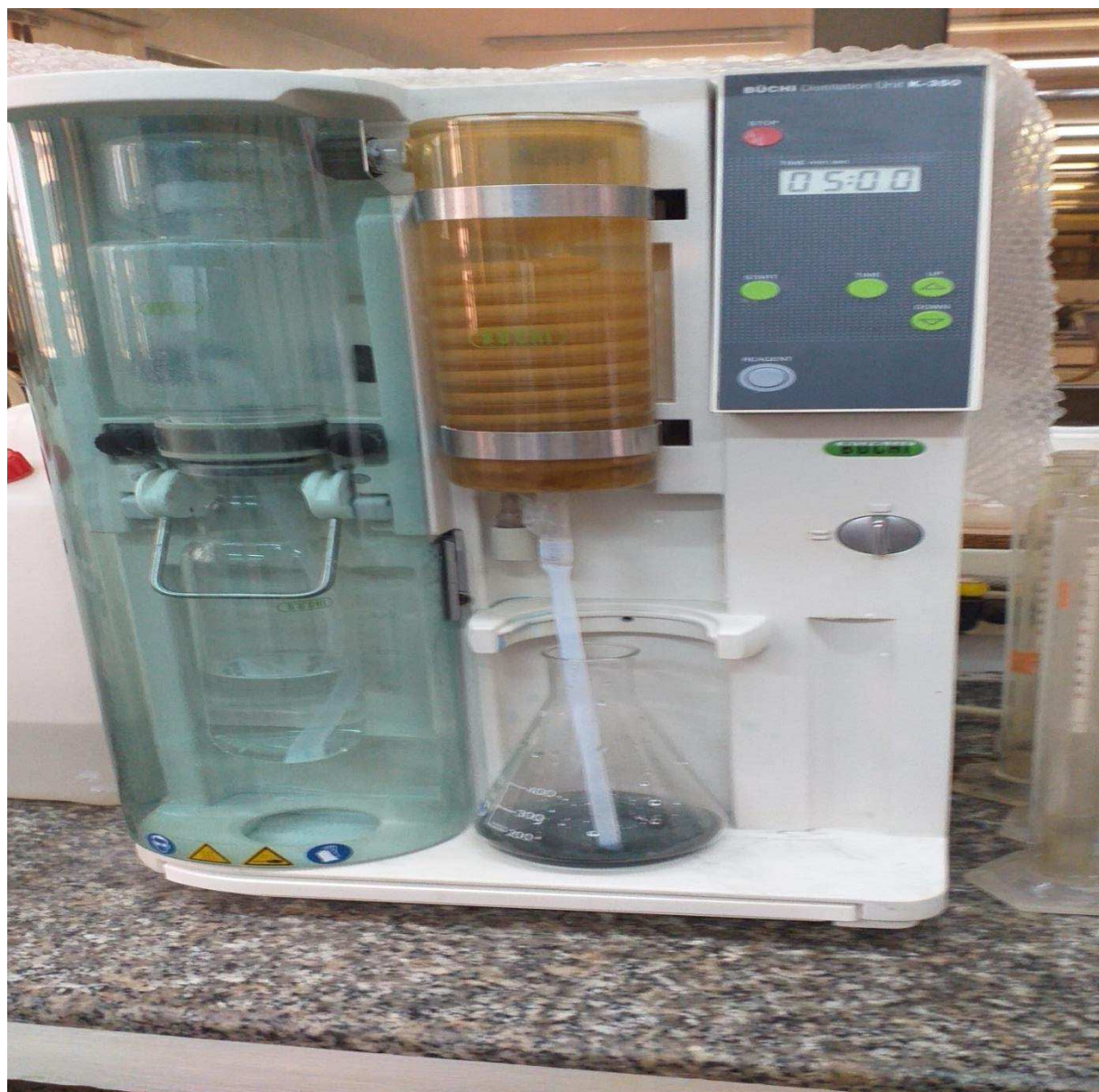
Figure.III-8 : Distillation de l'ion d'ammonium par un distillateur d'Azote Kjeldahl (BÜCHI Distillation Unit K-350).
