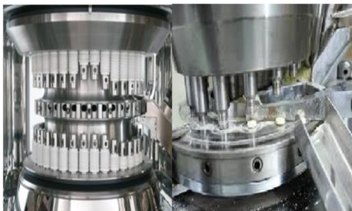
Figure.II.9 : Compresseurs rotatif modèle KILLIAN RTS 32.
