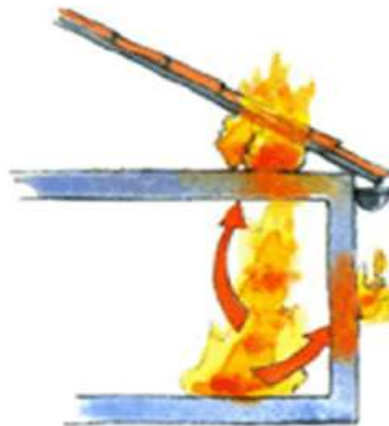
Fig. I.10. Propagation du feu par conduction [ISC].
