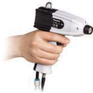
Figure III.4 : ionisation de l'air par un pistolet
