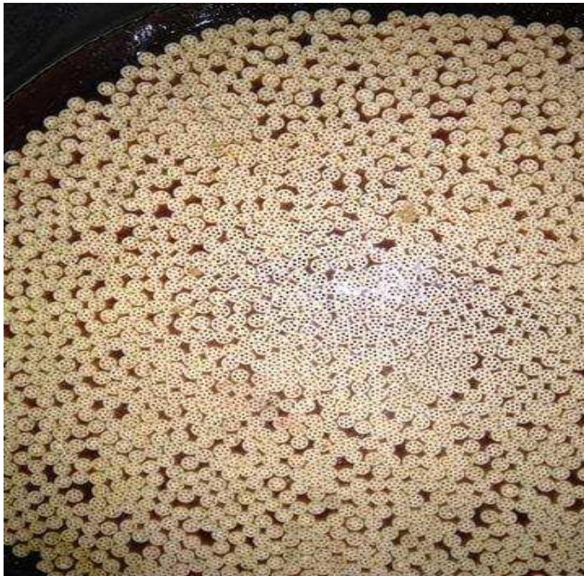
Figure II.10 : Membrane colmatée
