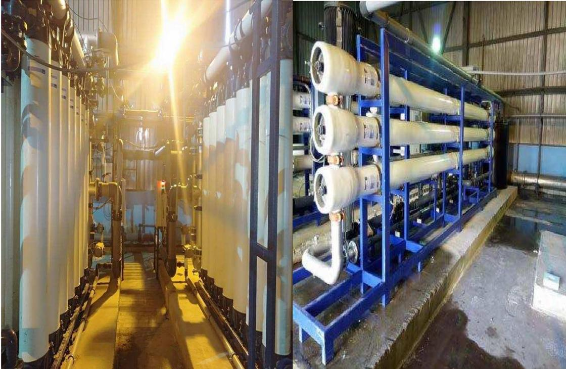
Figure II.6 : Installation d'ultrafiltration    Figure II.7 : Installation d'osmose inverse
