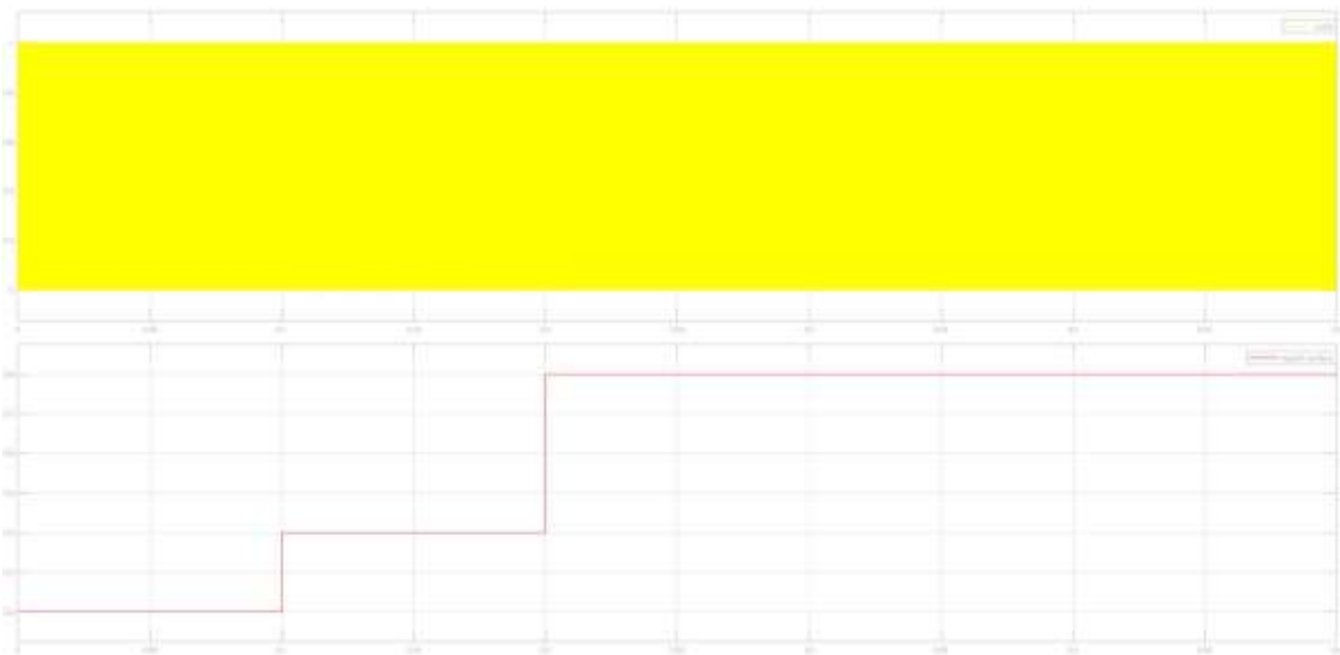
Figure 3.12 Pulsation PWM et rapport cyclique
