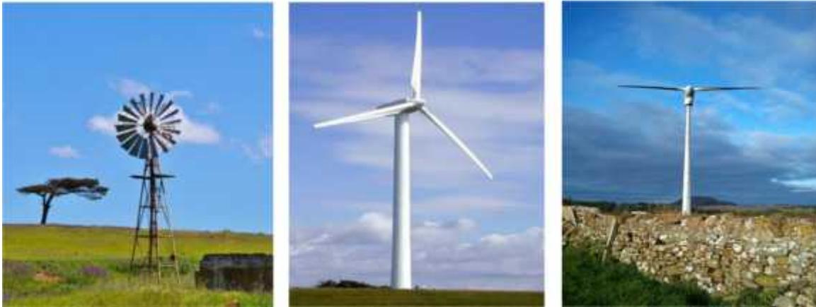
Figure 1.15 Les éoliennes à axe horizontal.
