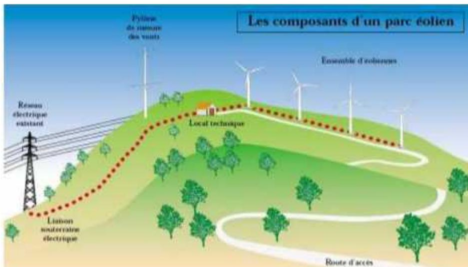
Figure 2.14. Les composants d'un parc éolien.
