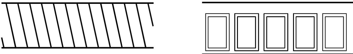
**Figure 3.7.** Schéma développé d'un rotor à cage classique et d'un rotor de machine asynchrone "brushless"
