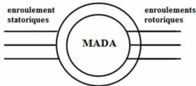
Figure 4.1. Symbole d'une Machine Asynchrone à Double Alimentation (MADA).
