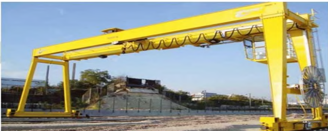
Figure 02 : Portique de manutention
