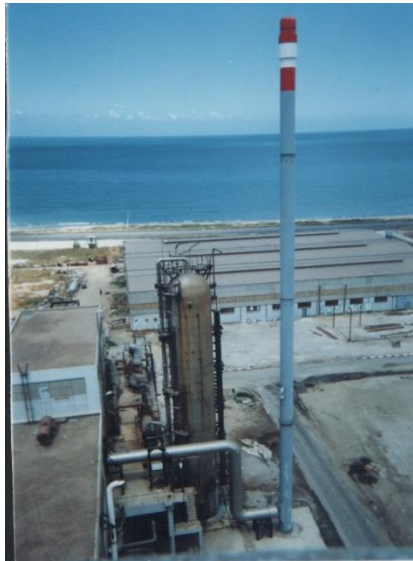
Fig. (I.10) : la colonne d'absorption-oxydation et blanchiment.
