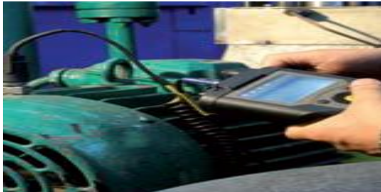
Figure 1.10 : vibcheck appareil de mesure des vibrations [5]
