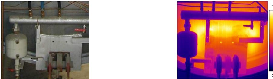
**Figure 3.1 :** Contrôle de défaut de calorifuge par thermographie sur un équipement sous pression
