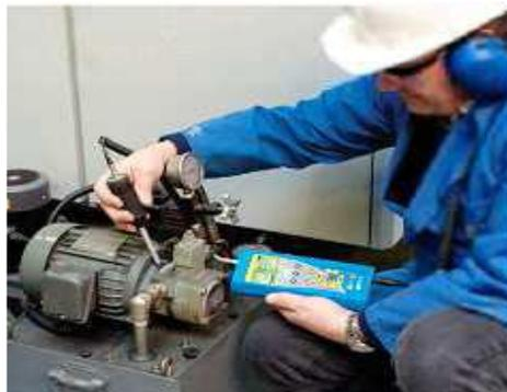
**Figure 3.5 :** Contrôle d'un groupe motopompe par ultrasons
