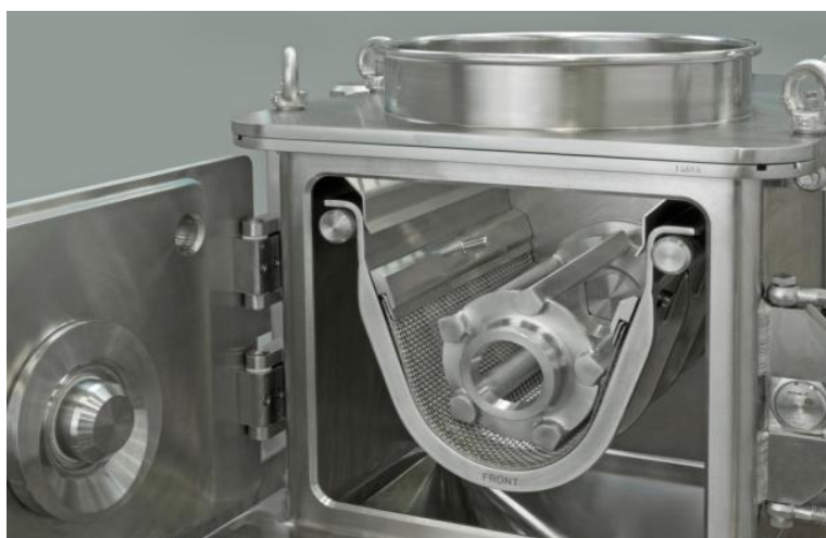
Figure II.5 : Appareil pour le calibrage « FREWITT »
