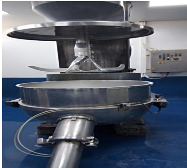
Figure II.4 : L'étape de mélange à l'aide d'un mélangeur granulateur de type COLETTE.
