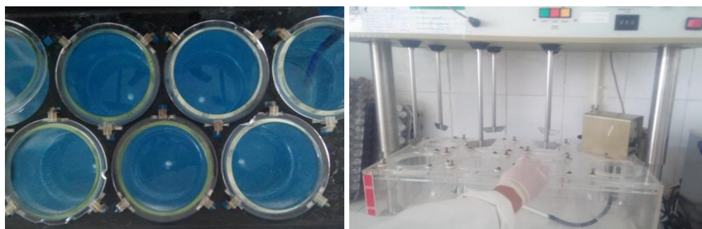
Figure III.5: Appareil de dissolution à palette tournante (dissolutest).
