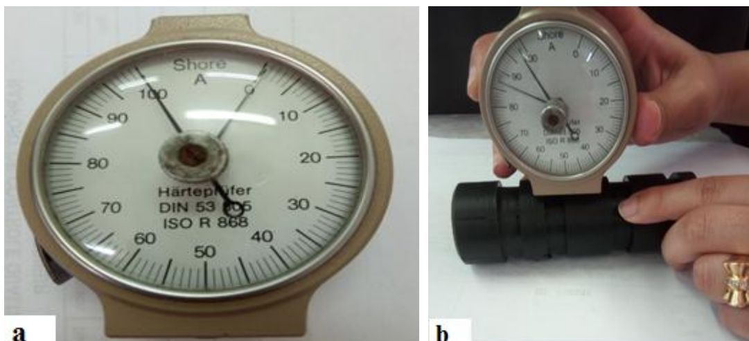
Figure III.3 : Dureté shore a)duromètre Harteprute, b) technique de mesure
