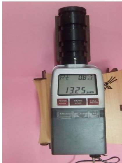
Figure III.2: Mesure de la rugosité
