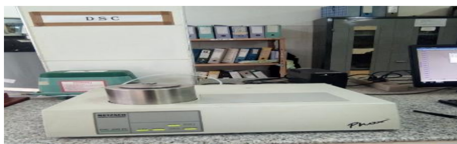
Figure III.7 : Calorimètre différentiel à balayage
