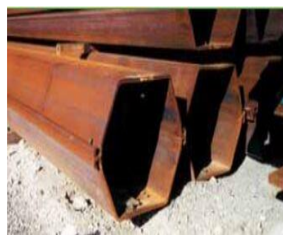
Figure I.11. Palplanches laminée à chaud[8]
