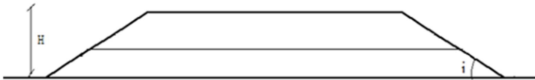
Figure 1.4 : Caractéristiques géométrique d'un remblai (4)
