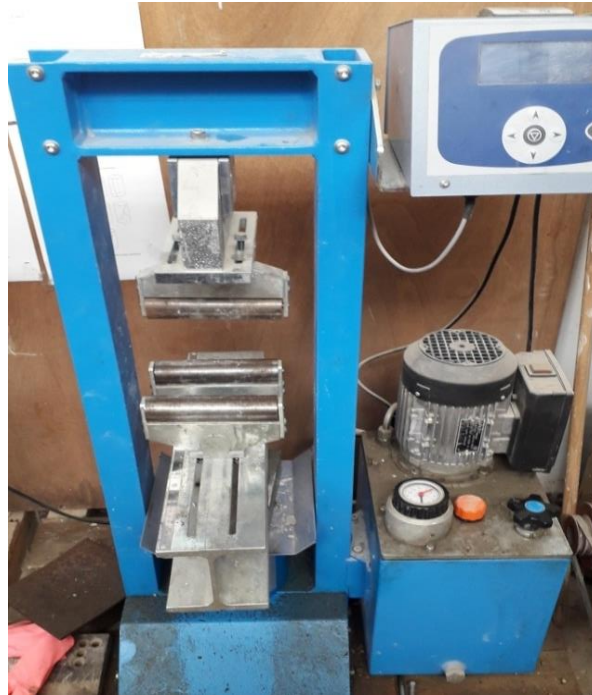
Figure IV.9 : Machine de traction par flexion
