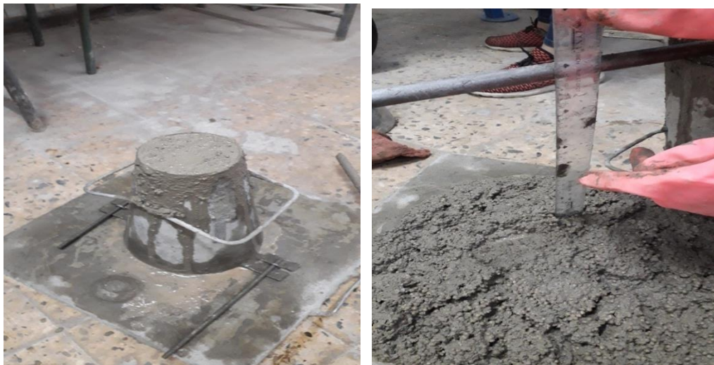
Figure III.2 : Essai de l'affaissement au cône d'abrams
