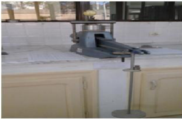
Figure I-13 : appareil d'essai Oedométrique
