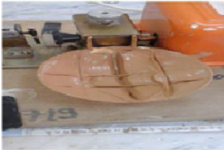
Figure I-11 : appareil de limite atterberg.
