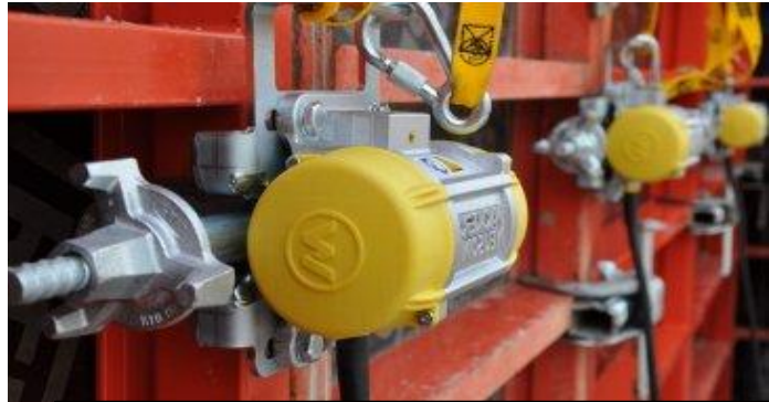
Figure I-31 : vibrateur fixe dans le coffrage
