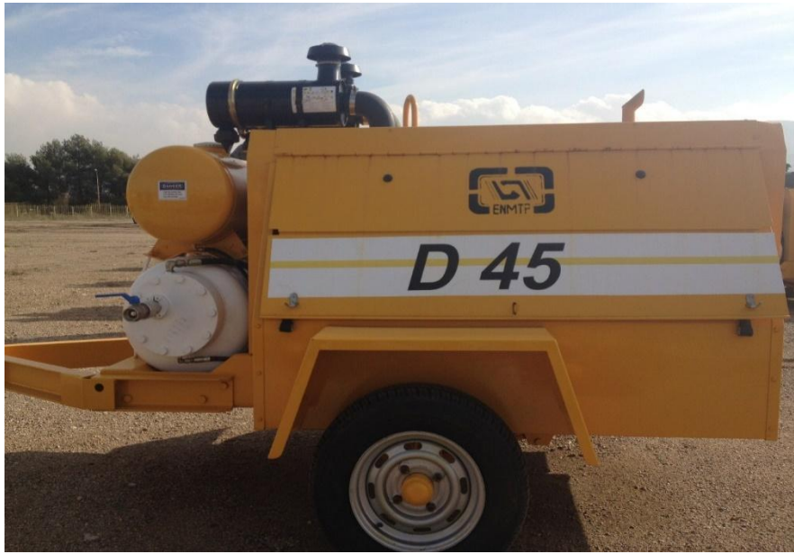
Figure II- 13 Compresseur d'air lié a la sableuse qui sert a donné une grande pression pour projeter le sable sec
