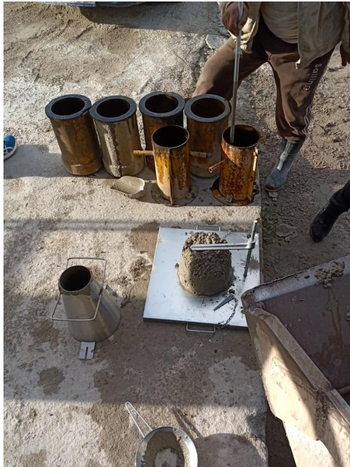
Figure I-32 : éprouvette de béton pour l'écrasement
