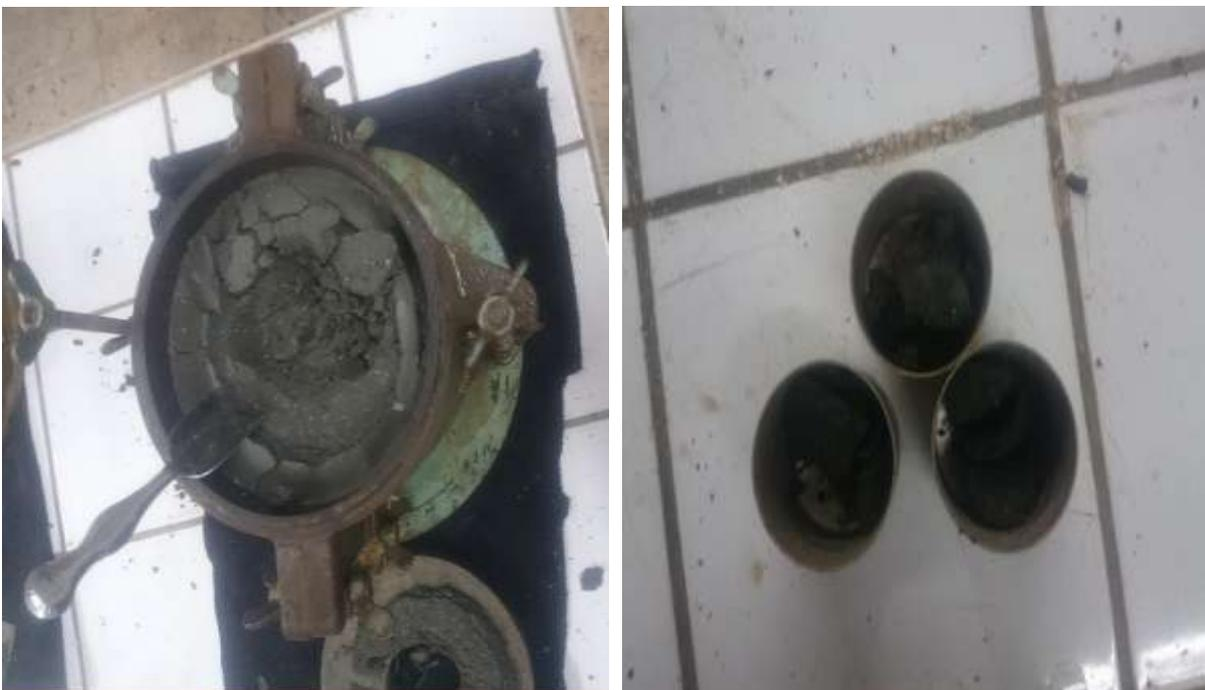
Figure 2.27 prélèvement des échantillons pour mesurer le teneur en eau
