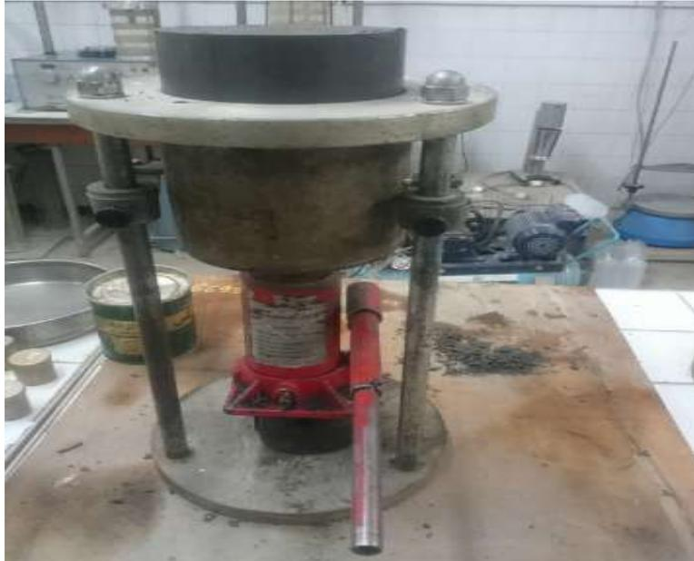
Figure 2.28 démoulage à l'aide d'extracteur
