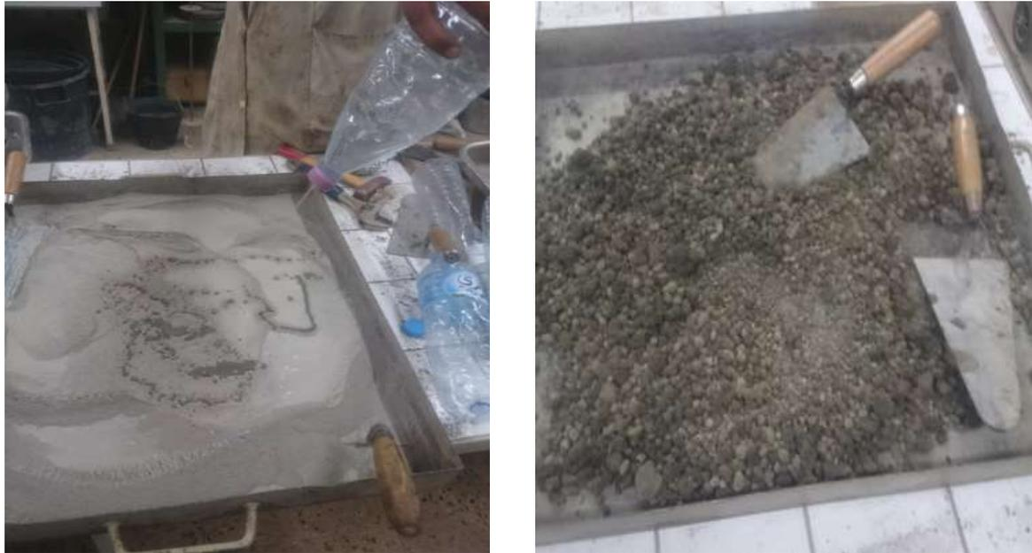
Figure 2.15 l'addition de l'eau et le sol humide non uniforme
