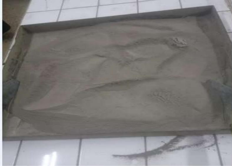
Figure 2.13 mélange uniforme sec du sol traiter au laitier activé
