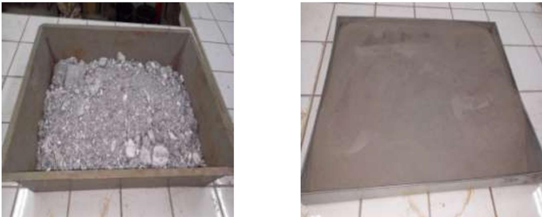
Figure 2.2 Kaolinite DD3 granulé et broyé
