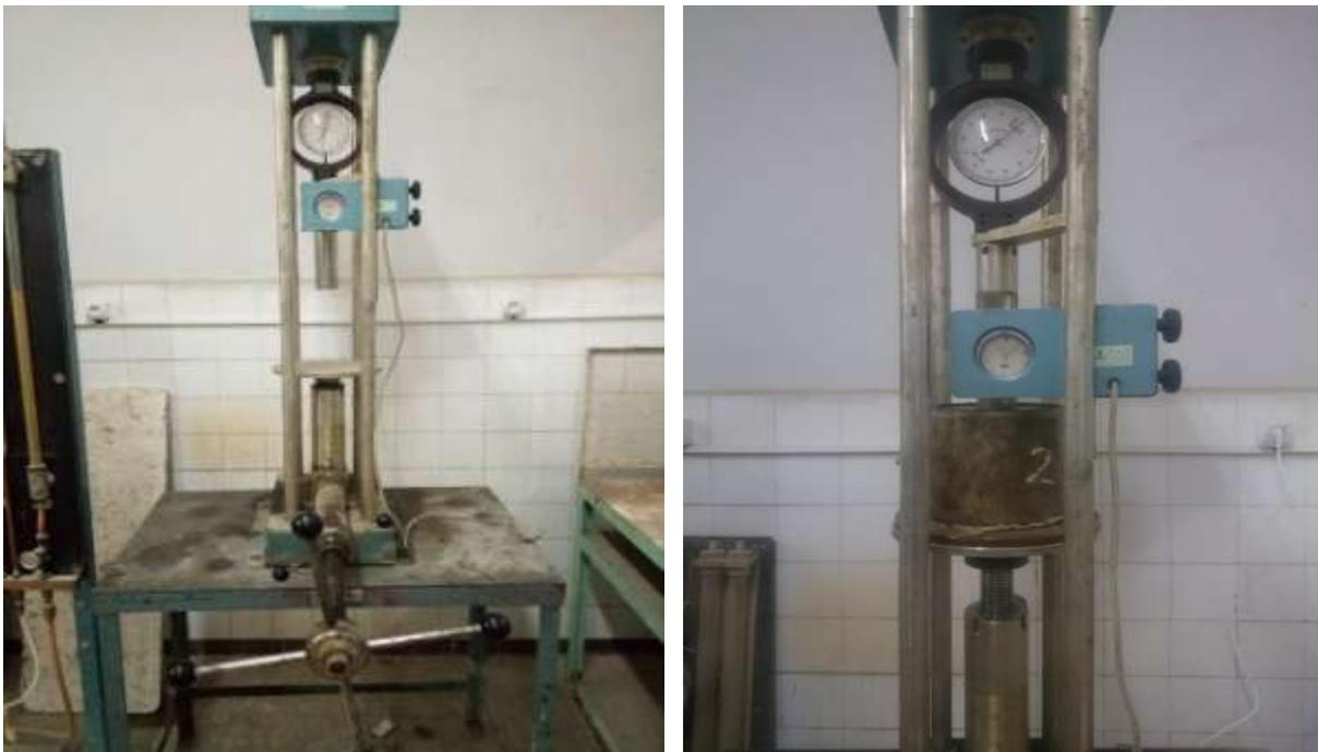
Figure 2.25 Préparation de la machine CBR et exécution de poinçonnement
