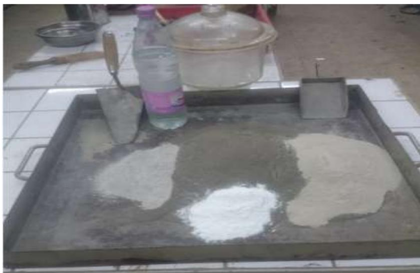
Figure 2.12 exemple de la composition du mélange étudié (DD3, bentonite, GGBFS, CaO)
