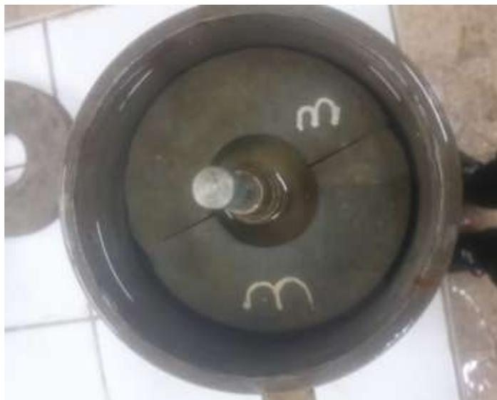
Figure 2.22 positionnement de disque de gonflement et les sur charge
