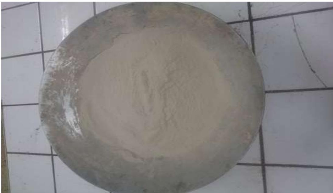
Figure 2.5 La bentonite utilisée dans cette recherche
