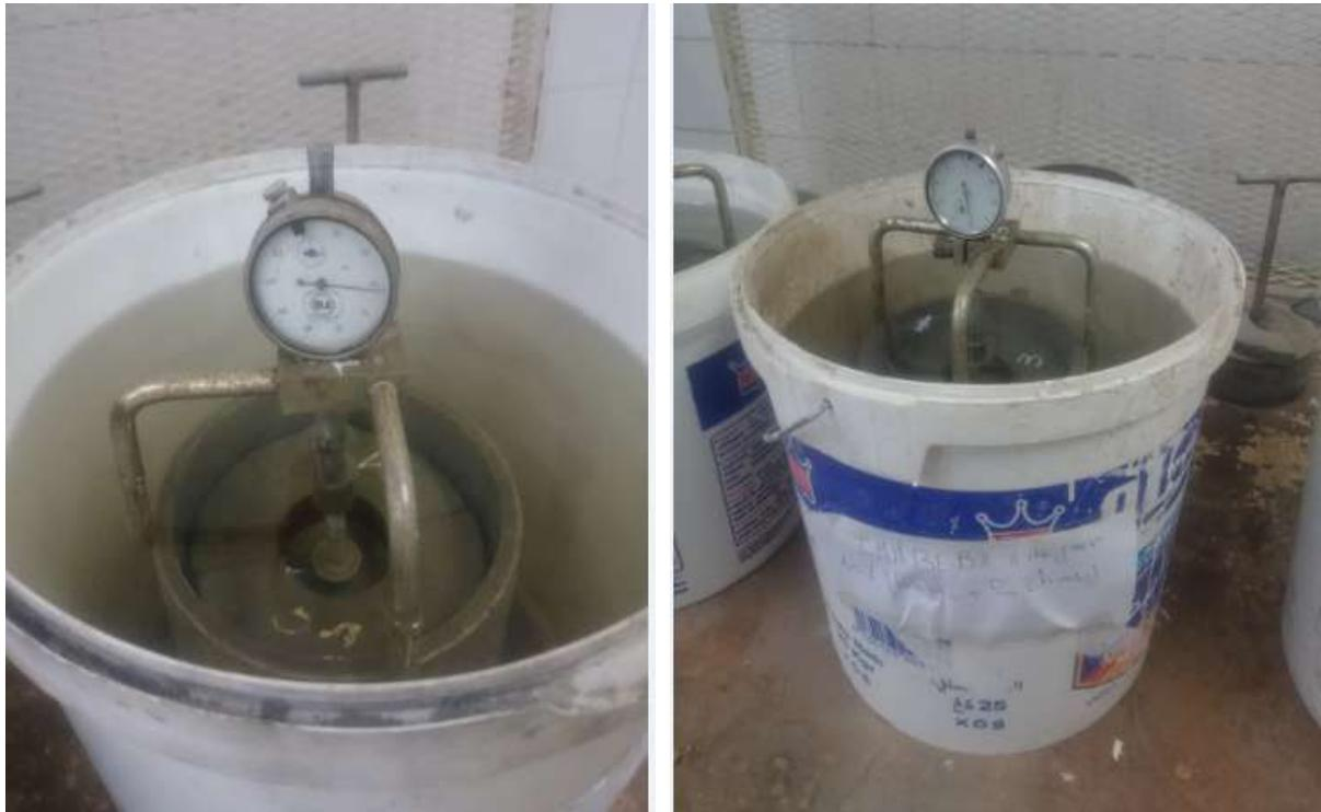
Figure 2.23 l'éprouvette de sol en cours d'imbibition
