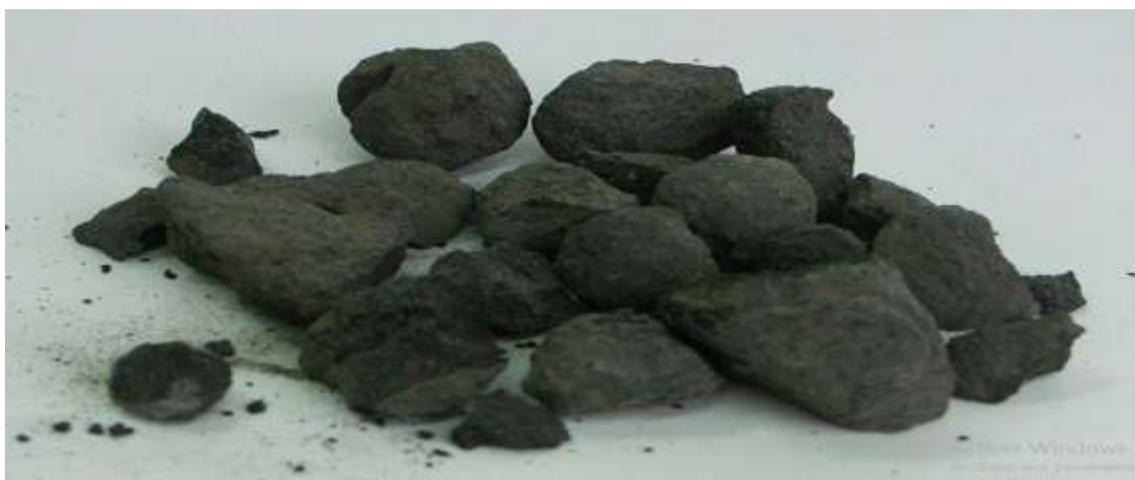
Figure 1.6. Photographie du clinker qui se présente sous la forme de nodules durs et cristallisés, de teinte gris foncé pour les ciments habituels
