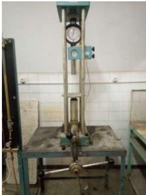
Figure 1.1 Machine universelle de l'essai CBR
