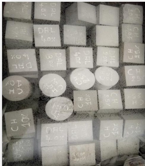
Figure II.10: Les éprouvettes immergées dans l'eau
