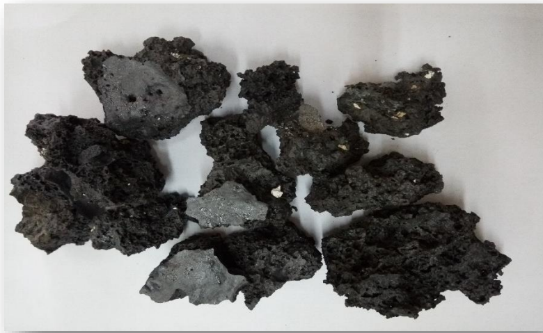
Figure II.4 : les scories avant le broyage granulat.
