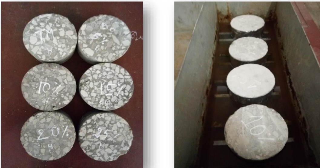
Figure II.14 : essai d'absorption capillaire
