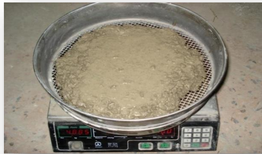
Figure II.8: Essai de stabilité au tamis pendant les deux minutes d'attente
