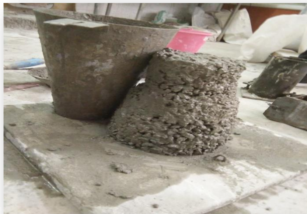
Figure II.9: essai d'affaissement au cône d'Abrams
