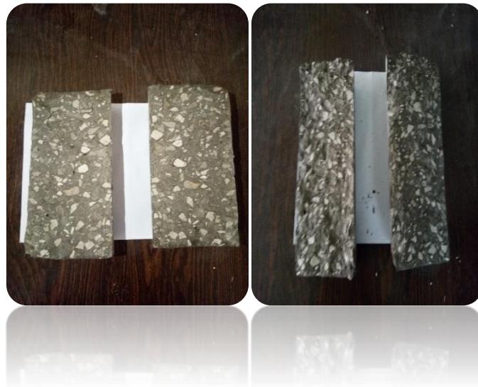
Figure 21 : vérification de l'absence de ségrégation 20% scorie, 25% scorie
