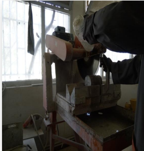
Figure II.13 : le sciage des éprouvettes à l'aide d'une scie à béton
