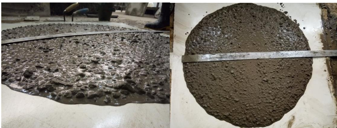
Figure II.6: Etalement d'un BAP homogène, bonne répartition granulaire, sans signes apparents de séparation des phases en périphérie de la galette
