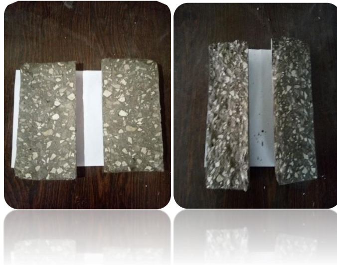
Figure IV-19: vérification de l'absence de ségrégation BAP témoin 0% scorie, 5% de scorie
