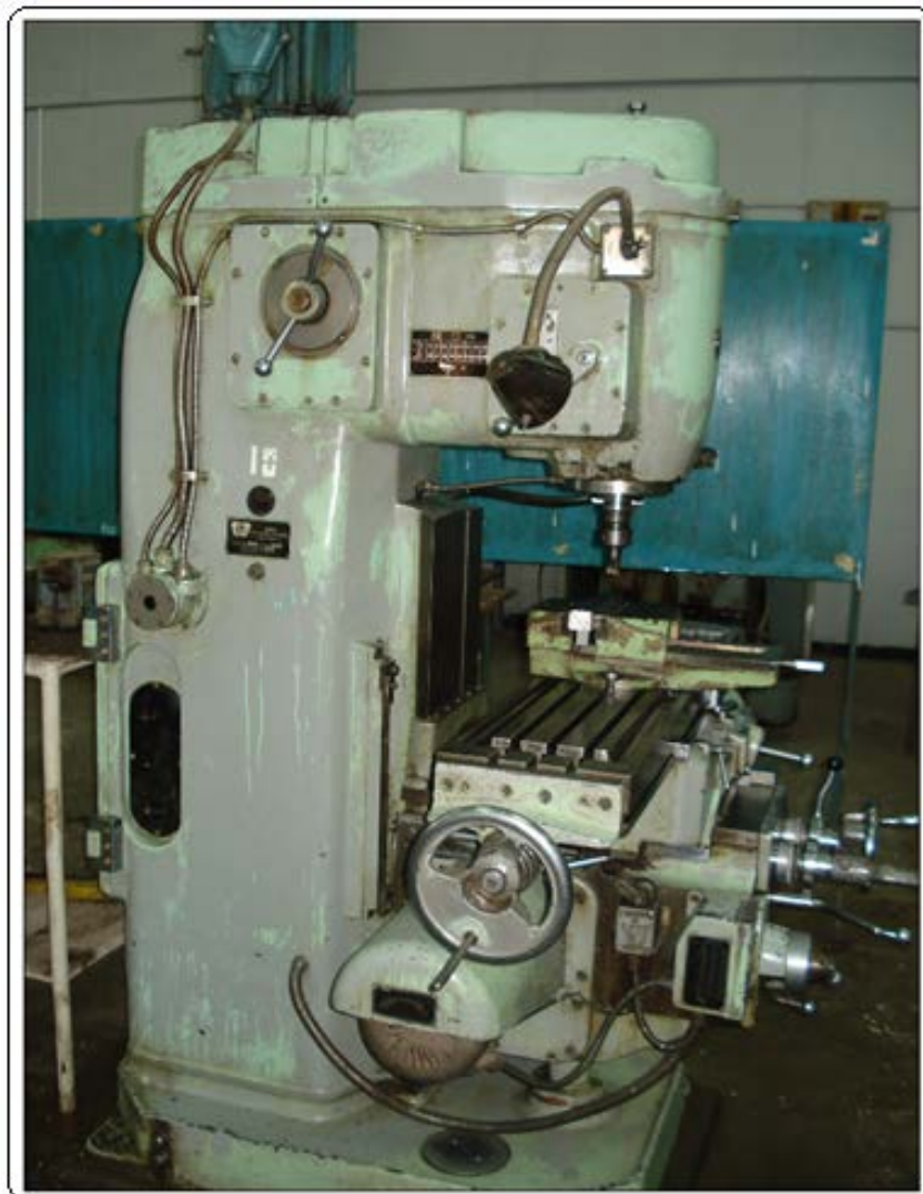
Figure II.1 : Fraiseuse verticale utilisée pour les essais
