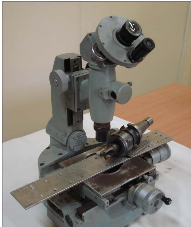
Figure II.6: Microscope optique modèle MMN-2.
