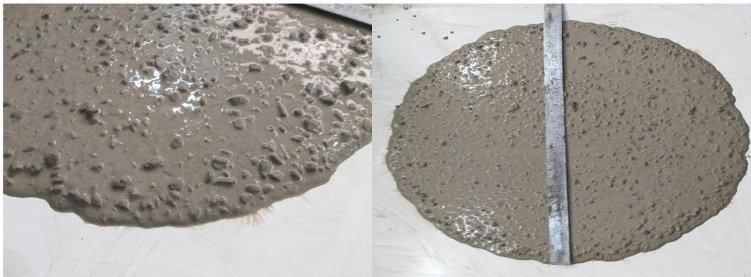
**Figure (III-2) :** Etallement d'un BAP homogène, bonne répartition granulaire
