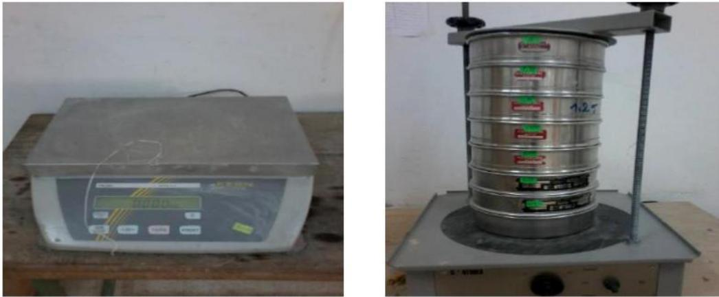
**Figure (II -1):** Matériels utilisé pour l'analyse granulométrique
