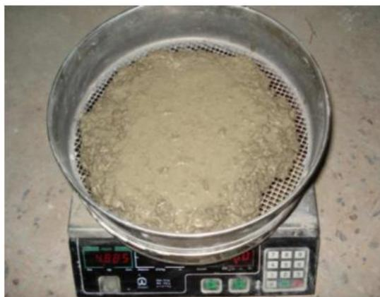
**Figure (III-3) :**Essai de stabilité au tamis pendant les deux minutes d'attente
