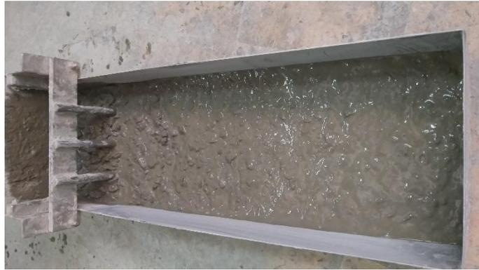
**Figure (III-4) :**Essai à la boîte en L en cours d'écoulement après remplissage
