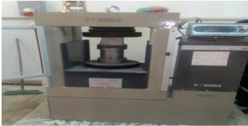
**Figure (I-13) :** Mesure de la résistance à la compression
