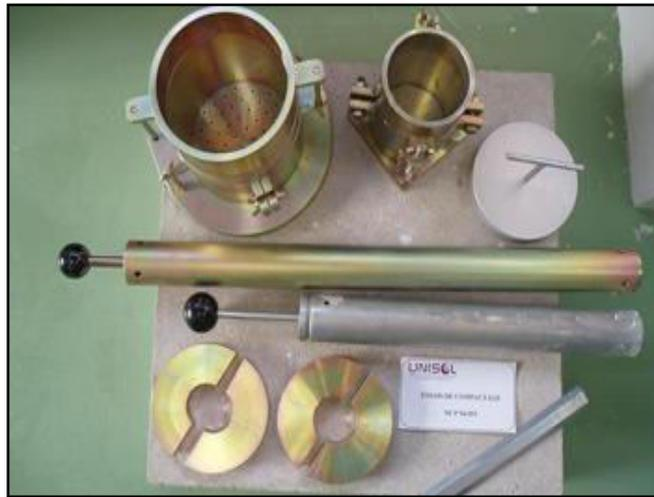
**Figure II.9** Appareillage nécessaire pour l'essai Proctor
