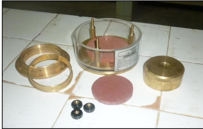
Figure II.16 Les composants de cellule oedométrique
