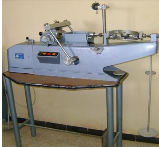
**Figure II.13** Appareil de Cisaillement Direct
