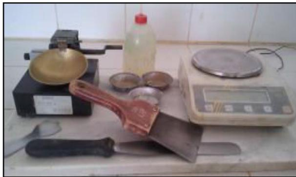
**Figure II.5** Matériel utilisé dans l'essai de Limites d'Atterberg
