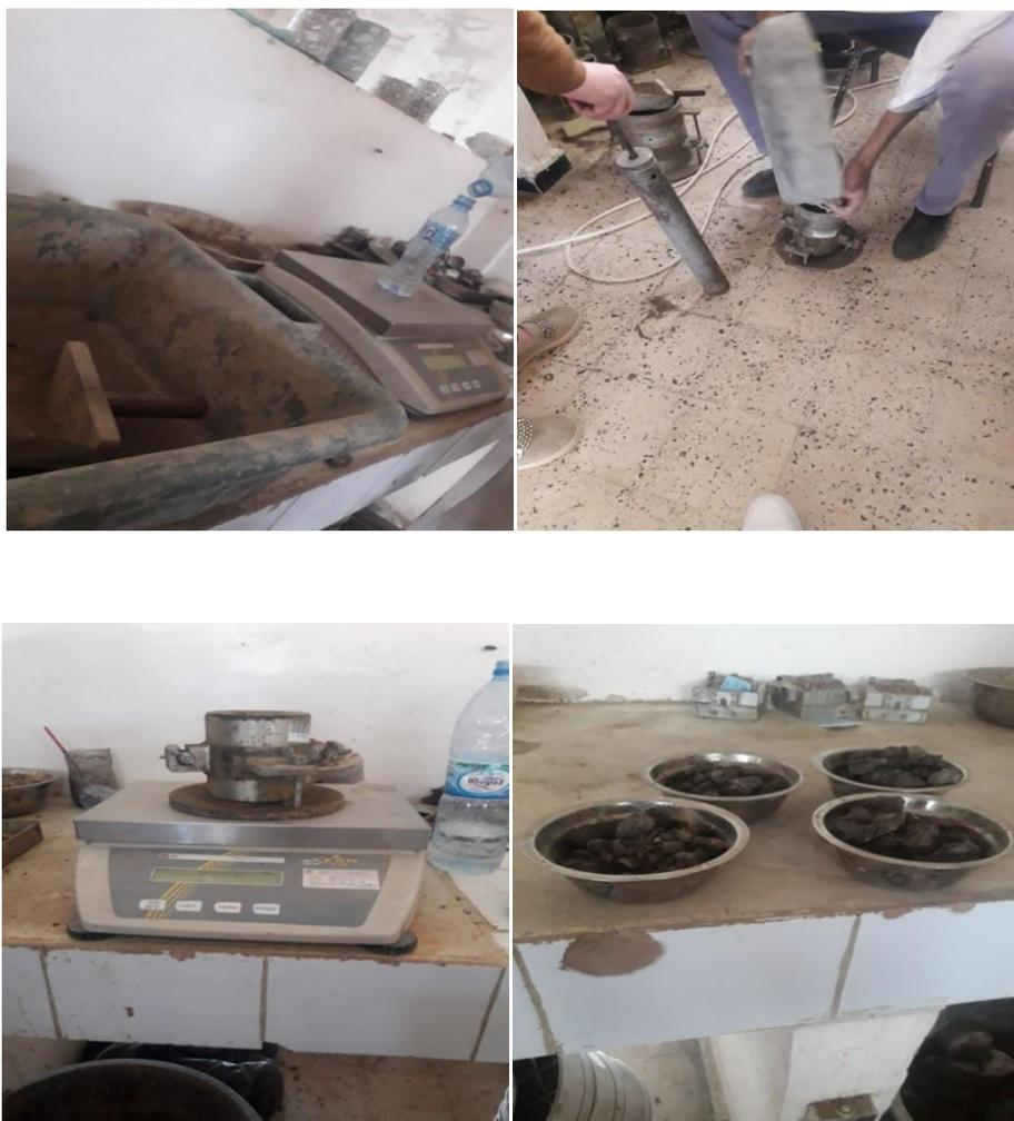
**Figure III.3** les étapes de l'essai Proctor
