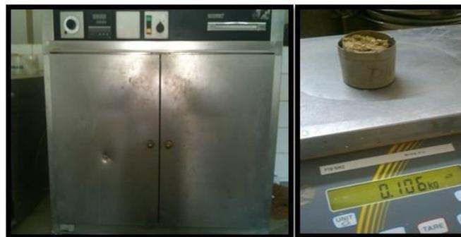
**Figure II.2** Détermination de la teneur en eau
