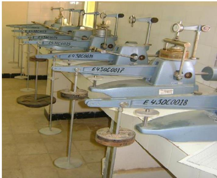
Figure II.17 Vue générale de l'appareil oedométrique
