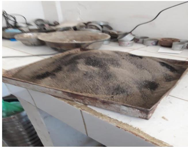
**Figure III.2** Mélange argile + déchet de pneu
