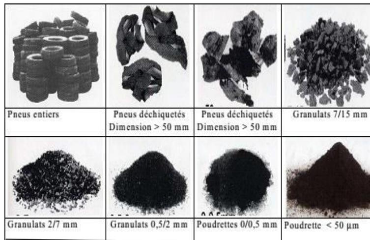
**Figure I.14** Schéma d'une filière de valorisation matière (Inter state 880/Dixon Landing Road, 2001)
