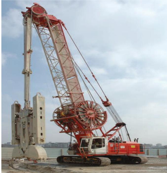
**Figure 1.2. Hydrofraise montée sur sa grue. Les débris détachés par les tambours sont pompés vers la surface avec la boue de forage.**
