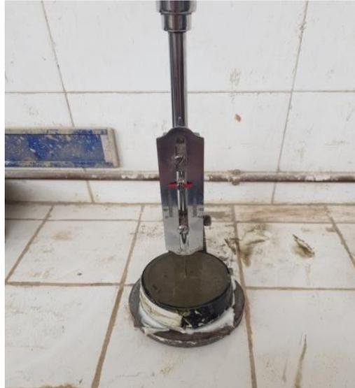
**Figure 2.16.**Détermination des délais de prise avec l'Appareil de Vicat
