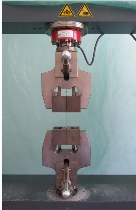
**Figure 2.13.**Essais de traction directe sur une fibre de palmier dattier
