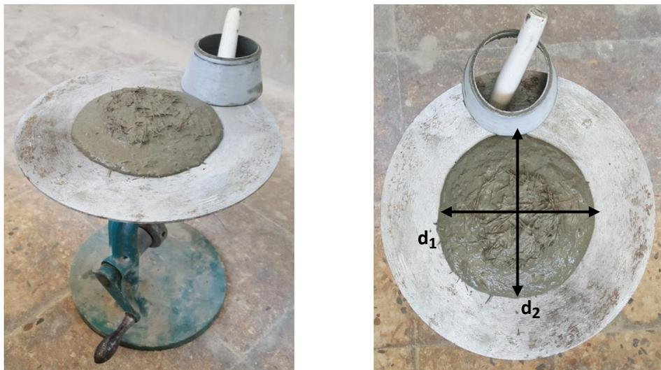
**Figure 2.14.**Etalement à la table à secousses
