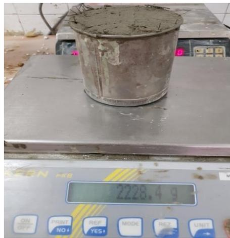
**Figure 2.15.**Mesure de la masse volumique réelle
