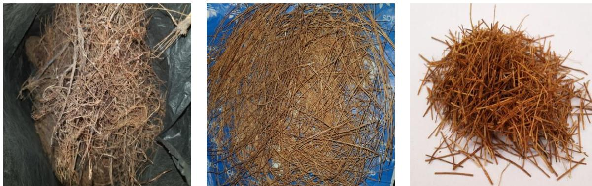
**Figure 2.4.** Préparation des fibres de palmier dattier
