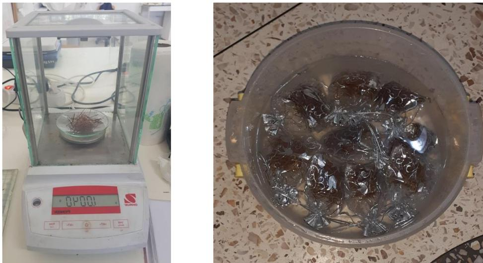
**Figure 2.10.** Suivi de la cinétique d'absorption des fibres de palmier dattier (laboratoire d'Ecole Des Minéraux).
