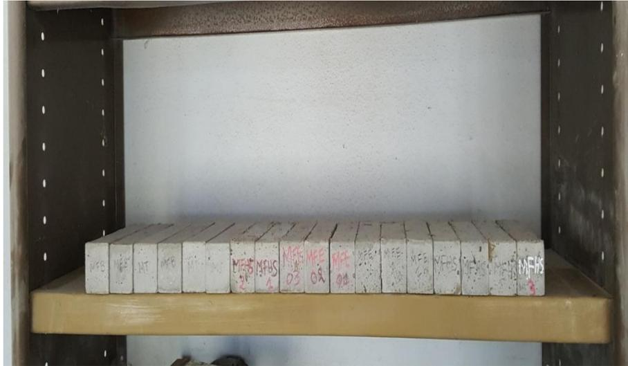
**Figure 2.9.** Conservation des éprouvettes
