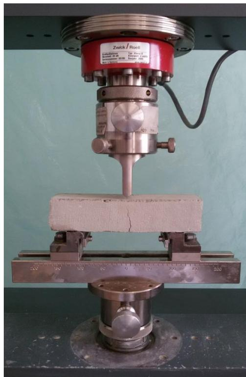
**Figure 2.17.**Essai de traction par flexion 3 points
