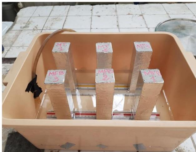
Figure 2.19. Essai d'absorption d'eau par capillarité
