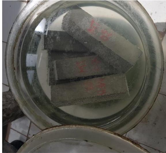
**Figure 2.20.**Essai de porosité accessible à l'eau
