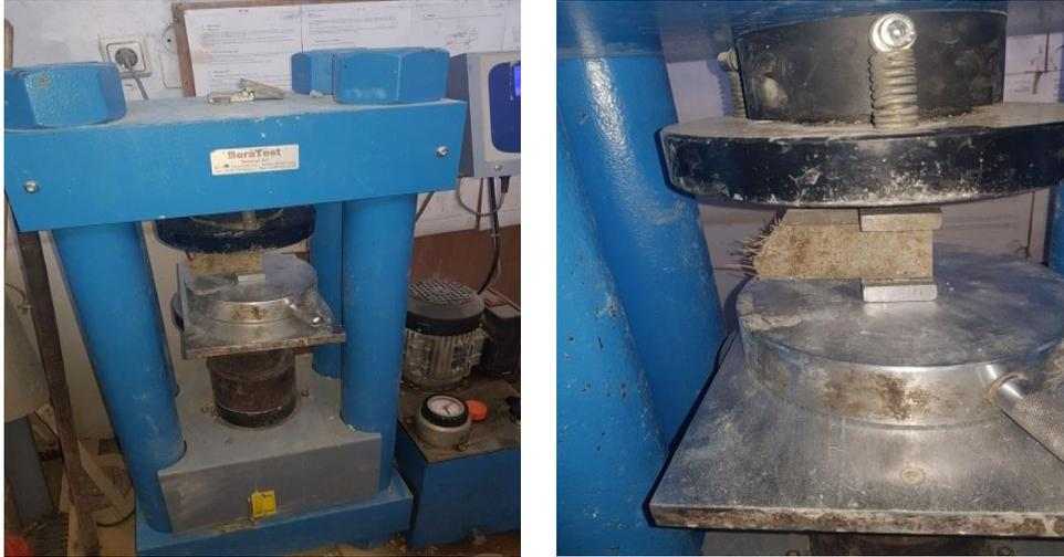
Figure 2.18. Presse hydraulique pour l'essai de compression
