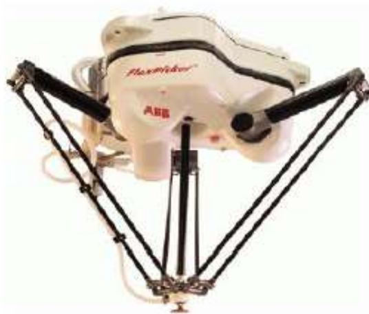
Figure I.7 Représentation du Delta à 4 degrés de liberté.
