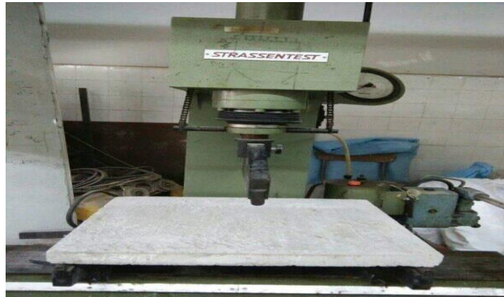
Figure III.4- description d'essai de flexion
