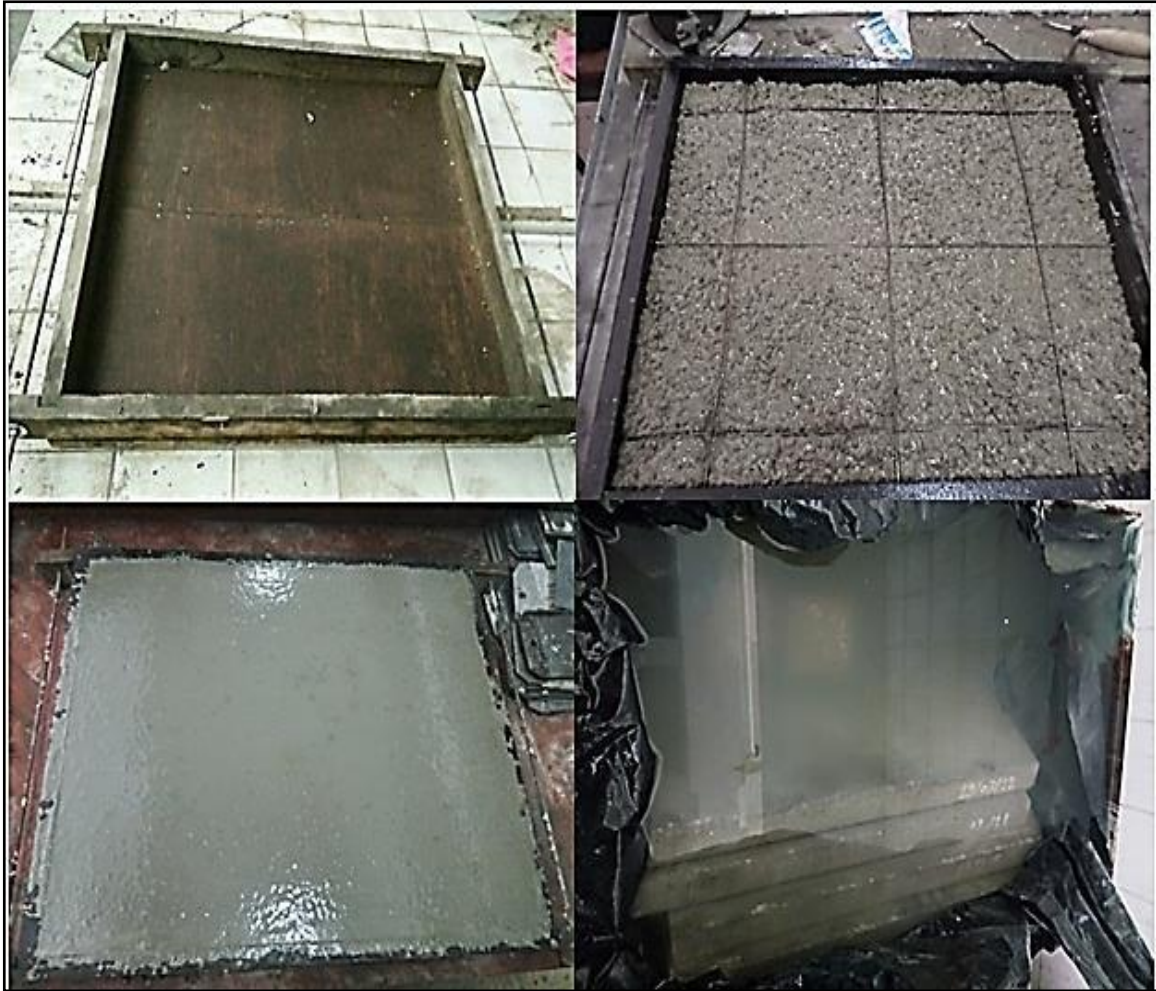
Figure II.17- Spécimens prismatique (dalles)
