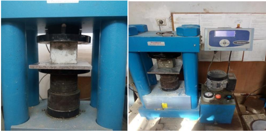
Figure III.1- description d'essai de compression
