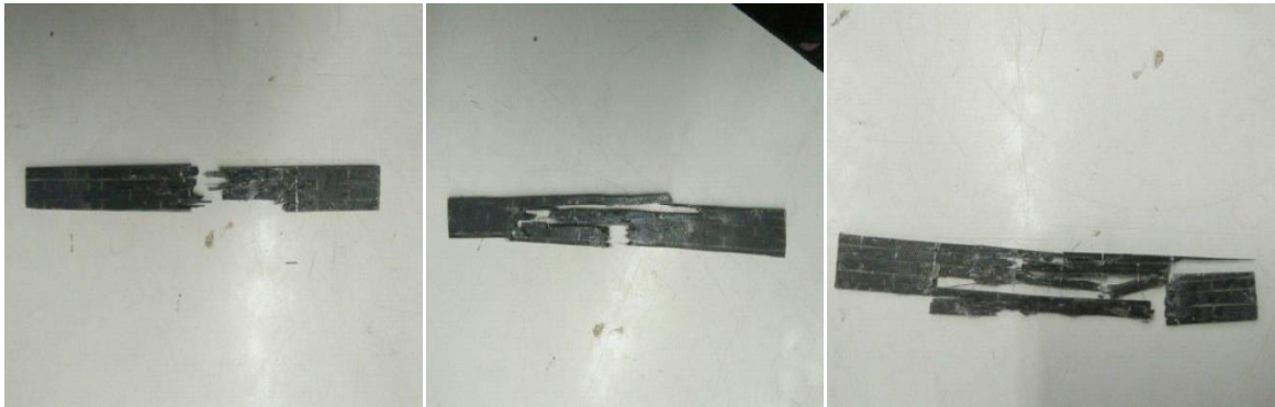
Figure III.5- Rupture du composite dans un essai de traction
