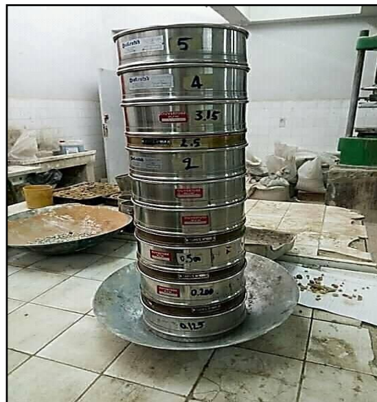
Figure II.7- la série des tamis
