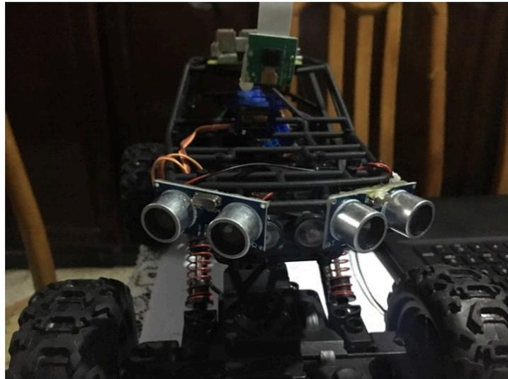
Figure III-8 :les capteurs ultrasons
