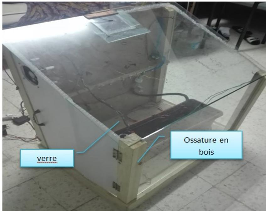
*Figure 45: Ossature de la mini serre agricole connectée.*
