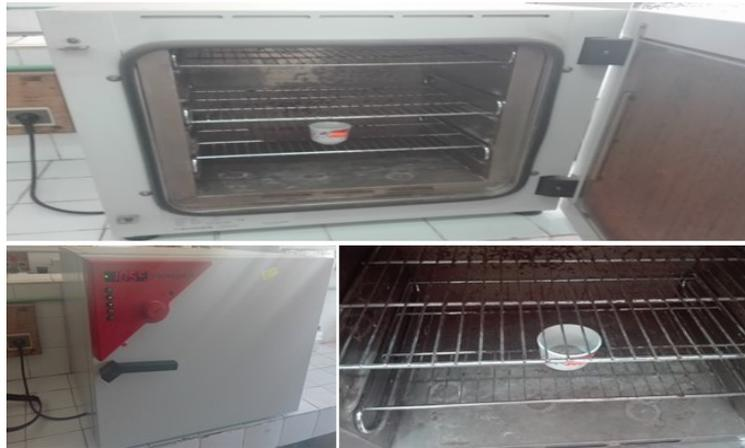
*Figure 22: Séchage dans l'étuve du témoin 1 à 105°C.*
