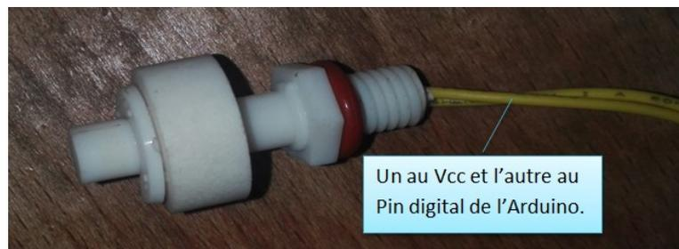
*Figure 16: Détecteur de niveau flottant*
